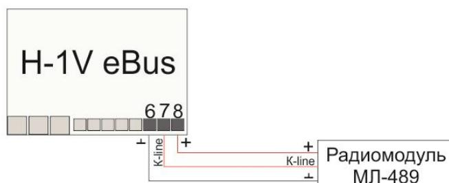
Чтобы Вход, к которому подключен Радиомодуль, мог обрабатывать информацию, в Настройках терmostата нужно обязательно указать назначение для данного входа – «**ОТ-адаптер, радиомодуль или не используется**»:
