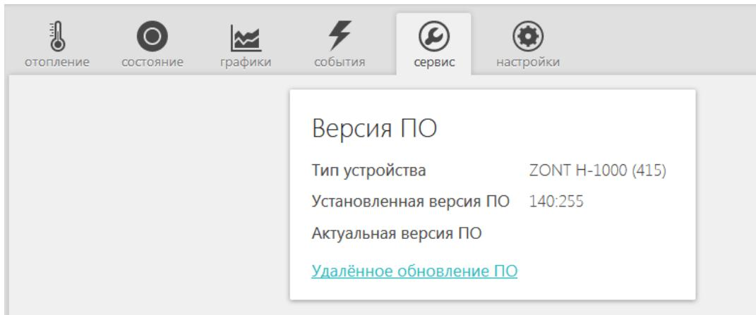
Для **автоматической** загрузки обновления можно выбрать версии рекомендуемые производителем или загрузить файлы обновления в **ручном режиме**.
