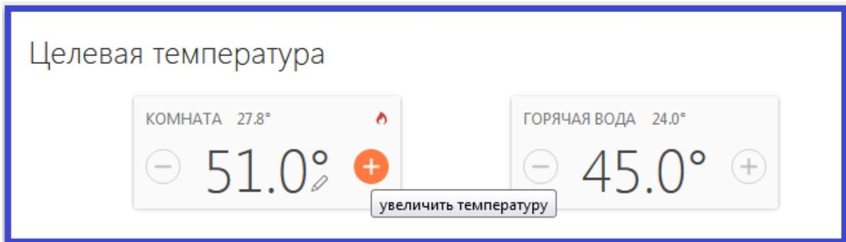
*Пример: Термостат работал в режиме «Комфорт». Вы не стали менять режим, а просто вручную изменили целевую температуру. Затем вы на какое-то время переключили термостат в режим «Эконом», а затем опять вернулись в режим «Комфорт». Целевая температура для режима «Комфорт» будет взята из прежних настроек, а введенная вами вручную - будет отменена.*
