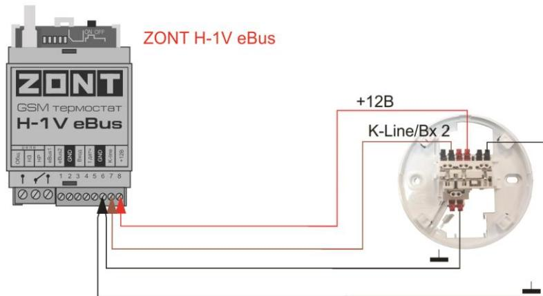
Чтобы Вход, к которому подключена панель управления, мог обрабатывать информацию, в Настройках термостата нужно обязательно указать назначение для данного входа – «**ОТ-адаптер, радиомодуль или не используется**»:
