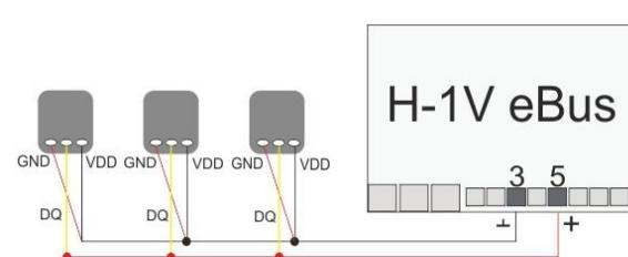
Датчик DS18B20 трехпроводной, но подключается по двухпроводной схеме:
