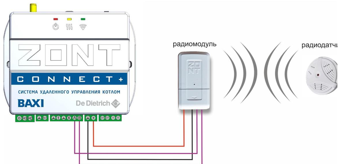
При подключении к Контроллеру радиомодуль автоматически появляется в настройках на вкладке “Настройки” — “Радиоустройства”.
