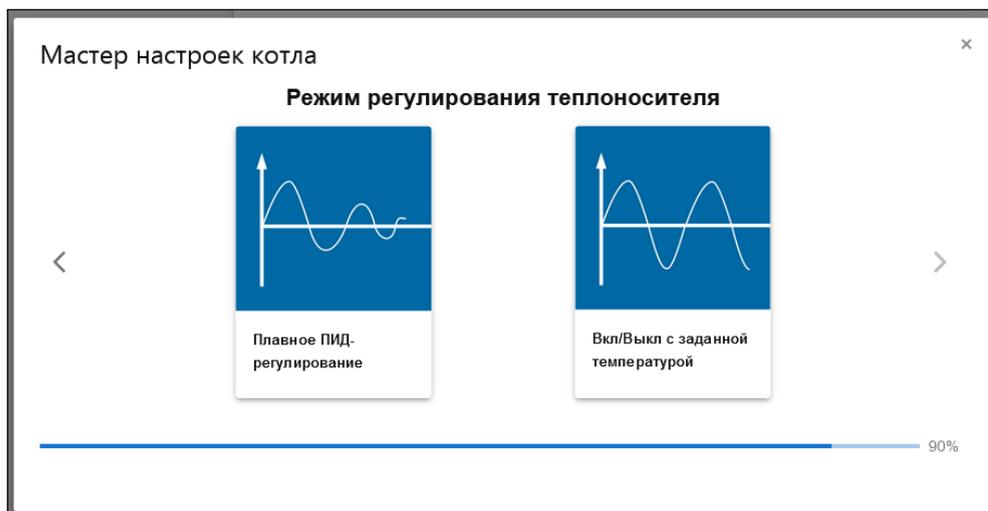
**“Плавное ПИД-регулирование”** - Режим рекомендуется для конденсационных котлов. Контроллер будет управлять отоплением по расчетной температуре теплоносителя, оптимальной для поддержания целевой температуры воздуха в помещении.
