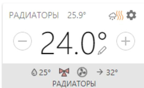
**24.0** – (в центре плашки контура) - целевое значение температуры для действующего данным контуре режима отопления. Графический элемент "**Карандаш**" - признак ввода целевой температуры в ручном режиме.
