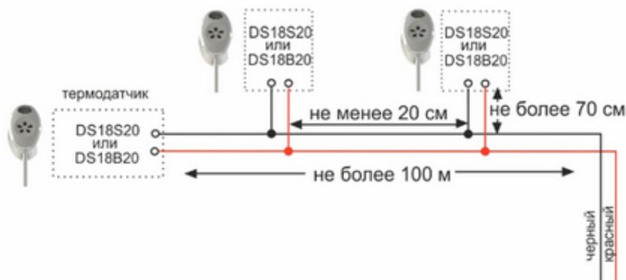
**ВНИМАНИЕ!!!** На кабельные линии (шлейф) цифровых датчиков действуют импульсные сетевые помехи. Запрещается прокладывать провода, к которым подключены датчики в одном кабельном канале с силовыми кабелями
