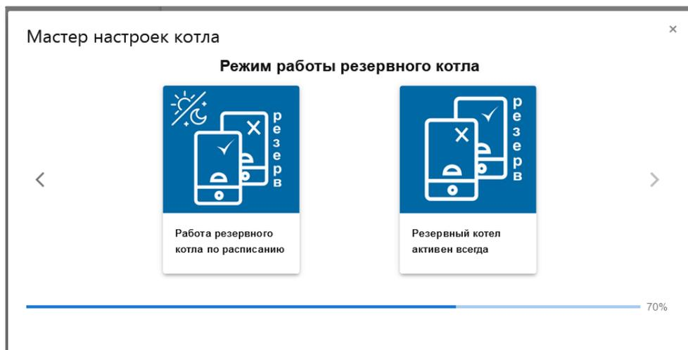
При выборе **“Работа резервного котла по расписанию”** Резервный котел работает в указанное настройкой время. В остальное время он или выключен или готов к включению при неисправности основного котла
