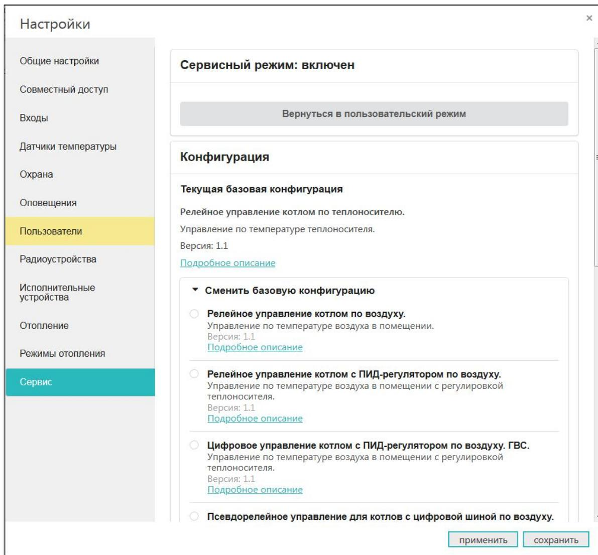
Для быстрой настройки Контроллера по одной из типовых конфигураций, необходимо выполнить подключения по рекомендуемой схеме и выбрать ее из предложенного списка. Далее нажать кнопку “применить”. Порядок подключения оборудования, датчиков доступны для просмотра при нажатии на ссылку “Подробное описание” конкретной конфигурации.
