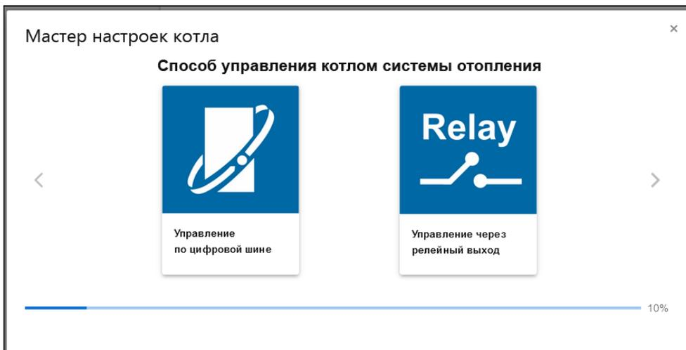
При выборе “Управление по цифровой шине” Контроллер будет рассчитывать температуру теплоносителя для действующего режима отопления и передавать в котел. Эта температура будет поддерживаться котлом за счет функции модуляции.
