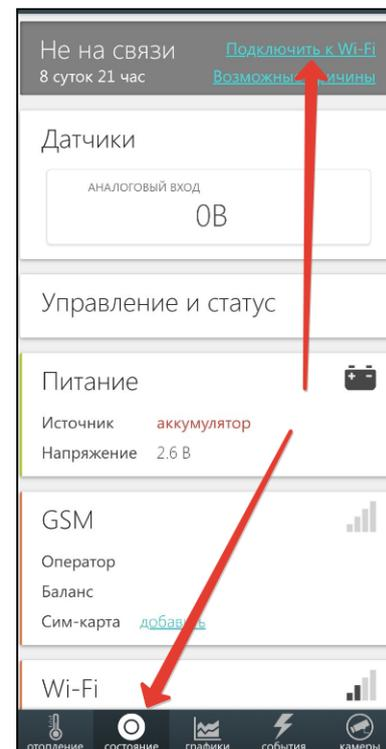
3. *Без использования сим-карты.* Временно отключите на роутере запрос пароля используемой Wi-Fi сети или создайте открытую точку доступа с помощью мобильного устройства. Контроллер всегда ищет открытые сети и установит связь. После этого укажите в настройках название и пароль сети Wi-Fi.
