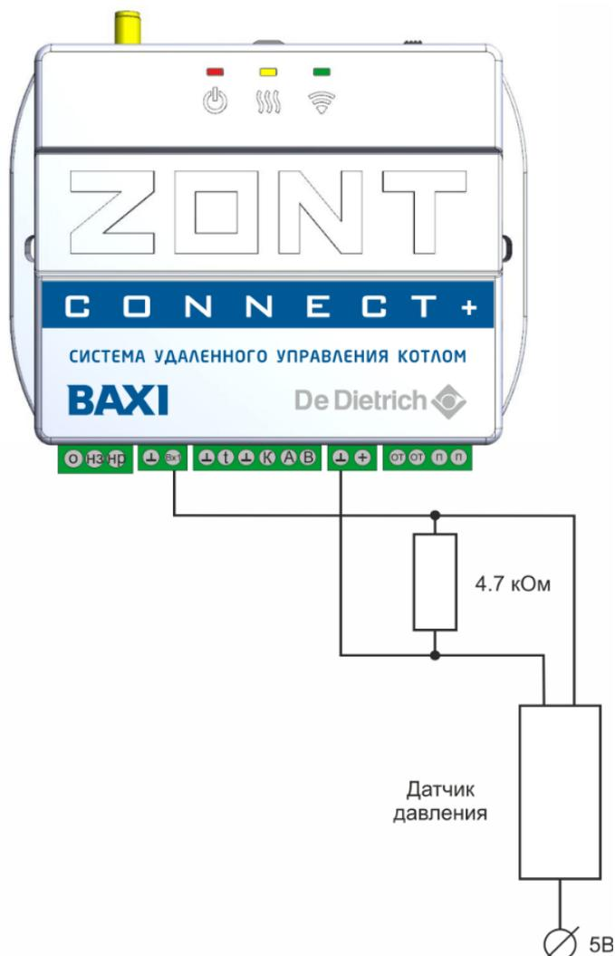
Номинальное напряжение на выходе датчика — от 0,5 В до 4,5 В. Опорные точки:
