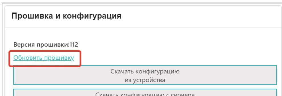
**ВНИМАНИЕ!!!** Во время обновления прошивки ни в коем случае нельзя отключать Контроллер от сети. В случае перебоев в питании и при не полностью заряженном внутреннем аккумуляторе может произойти сбой, что приведет к полной неработоспособности Контроллера. Восстановление работоспособности в этом случае возможно только в заводских условиях.
