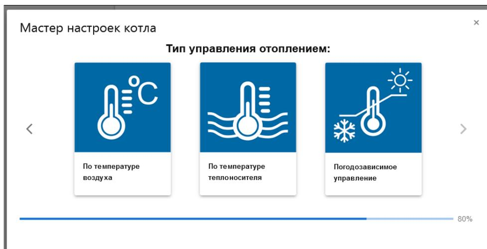
При выборе **“По температуре воздуха”** Контроллер будет управлять отоплением по температуре воздуха в помещении. Датчик из комплекта поставки нужно установить для контроля текущей температуры воздуха.
