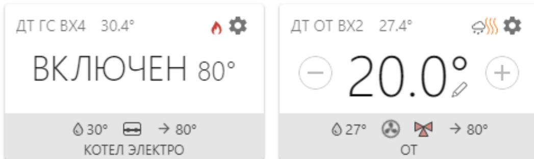
Графический символ **“Реле”** – признак состояния выхода контроллера.
