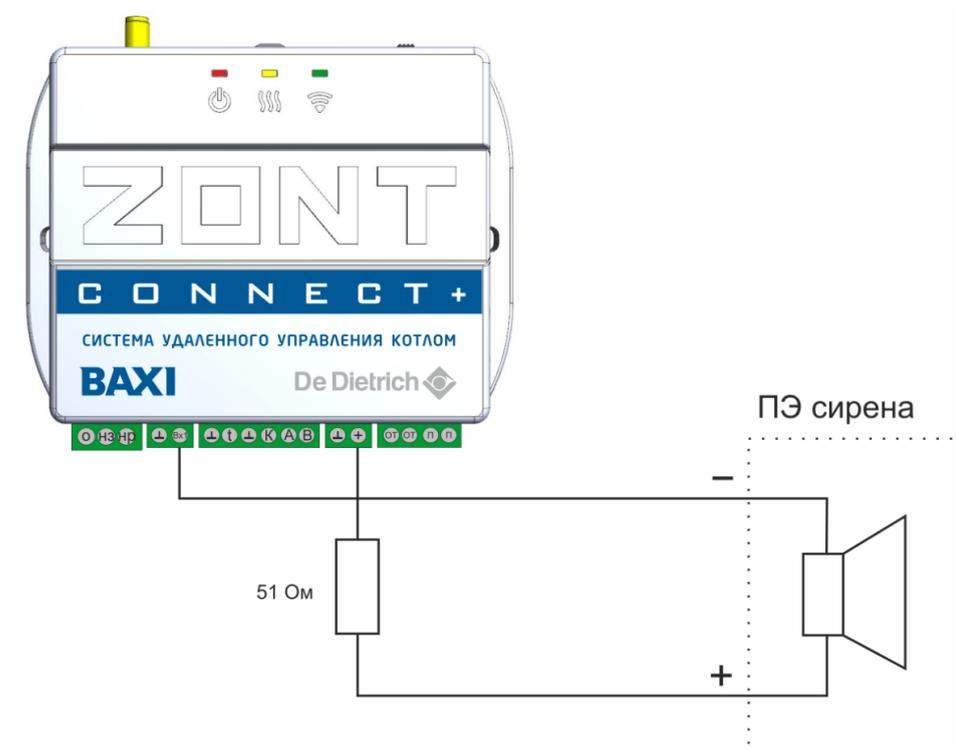
Сирена предназначена для звуковой индикации срабатывания охраны, постановки на охрану и снятия с охраны. Настройка алгоритма работы сирены применяется в режиме «Охрана».
