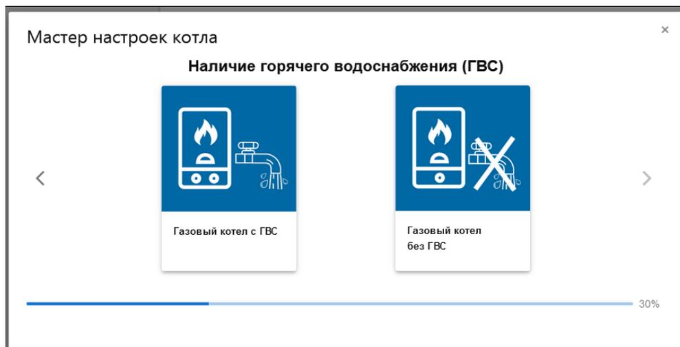
Выбрать **“Газовый котел с ГВС”** если функцию приготовления горячей воды выполняет электроника котла
