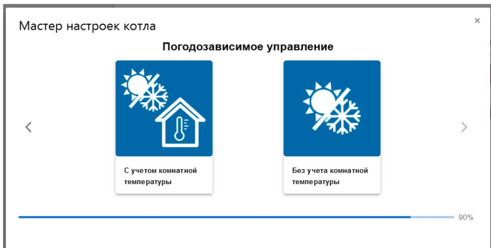
**“С учетом комнатной температуры”** - Контроллер будет управлять отоплением по температуре теплоносителя, вычисленной алгоритмом ПЗА с учетом изменения погоды. В помещении при этом поддерживается целевая температура воздуха.
