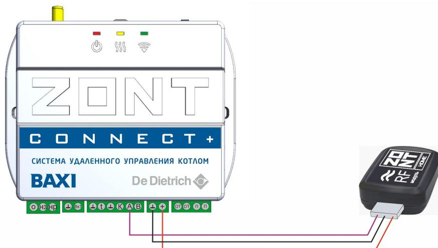
Подключение радиомодуля ZONT МЛ-590 осуществляется по цифровому интерфейсу RS-485 к одноименным клеммам контроллера (полярность А и В важна). с помощью проводов (в комплект прибора не входят).
