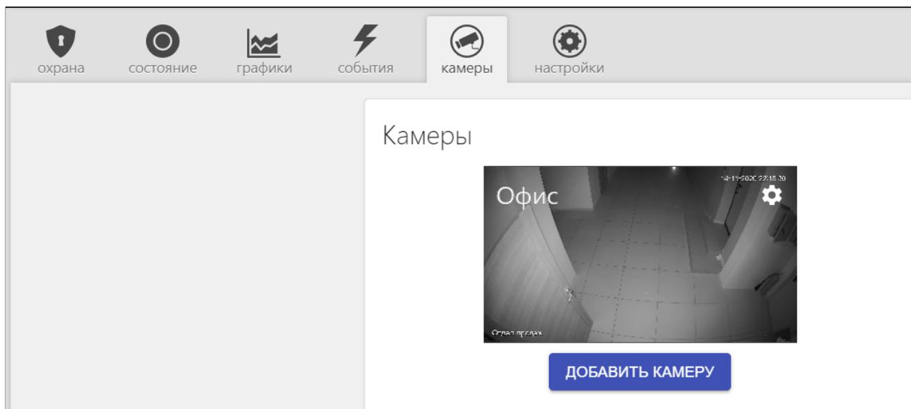
IP-камера снимает видео и транслирует его в реальном времени по закрытому каналу. Доступ к каналу можно получить с помощью специализированных программ при использовании RTSP-ссылки на видеопоток камеры.
