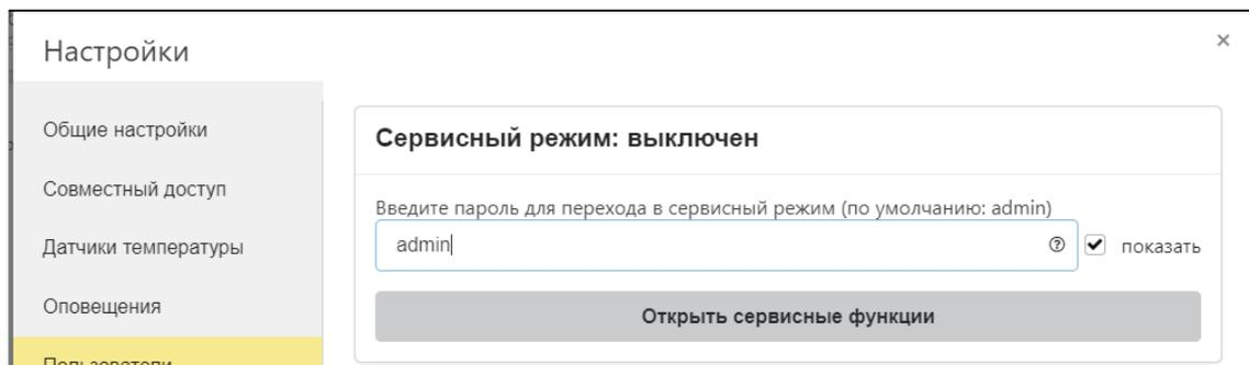
В сервисном режиме доступны настройки входов Контроллера и действий с ними, настройка исполнительных устройств и элементов управления.
