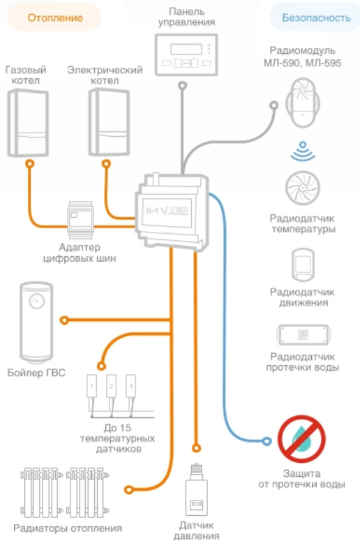
Пример инженерной системы на базе ZONT H-1V.02
