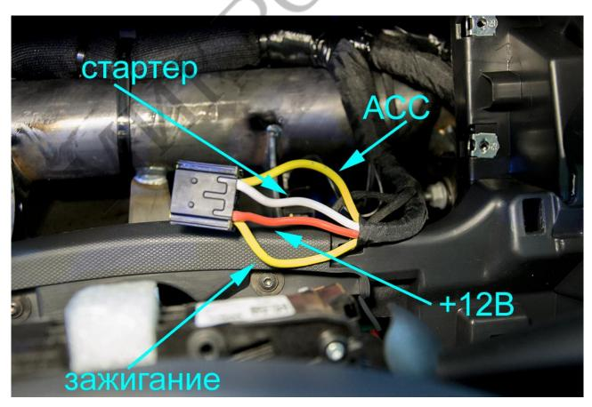
Для обхода штатного иммобилайзера на время Автозапуска уложите запасной ключ в транспондерный обходчик, согласно инструкции по установке обходчика. Разместите антенну обходчика на считывателе ключа.
