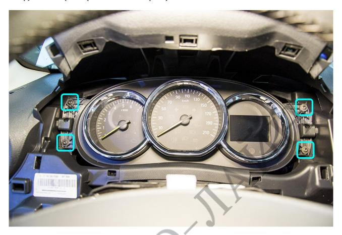
Щиток приборов снят. Общий вид. Возможное место размещения блоков и модулей комплекса, а также возможное место подключения массы к штатной проводке.
