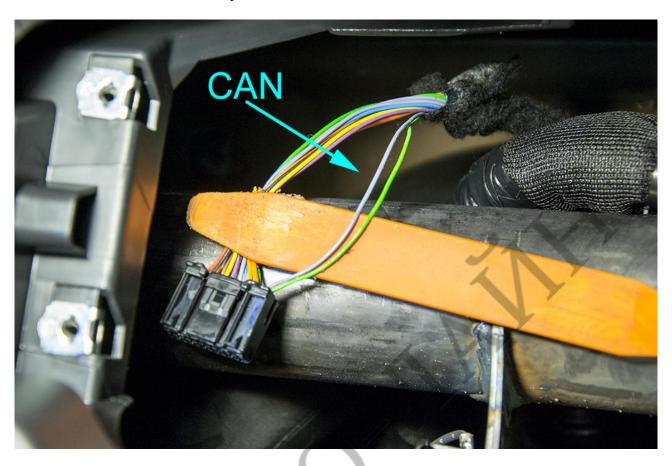
Подключите вход концевика капота к бежевому проводу в жгуте серого разъёма блока ВСМ.
