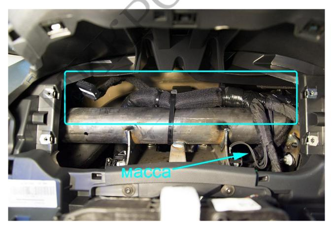
Подключите CAN-шину сигнализации в жгуте щитка приборов. CAN-H — Зелёный, CAN-L — Серый.
