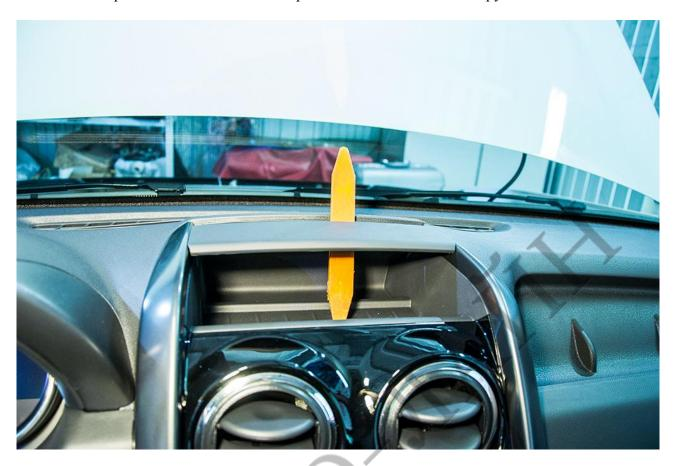
Снимите центральную накладку панели. На защёлках.
