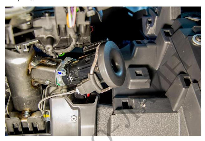
Проложите провода под капот. Возможное место установки сирены на штатную шпильку.
