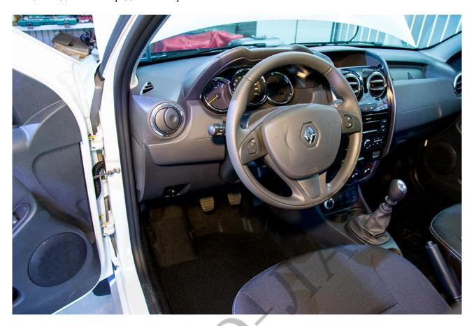
Выньте клипсы накладки в ногах водителя и снимите её.
