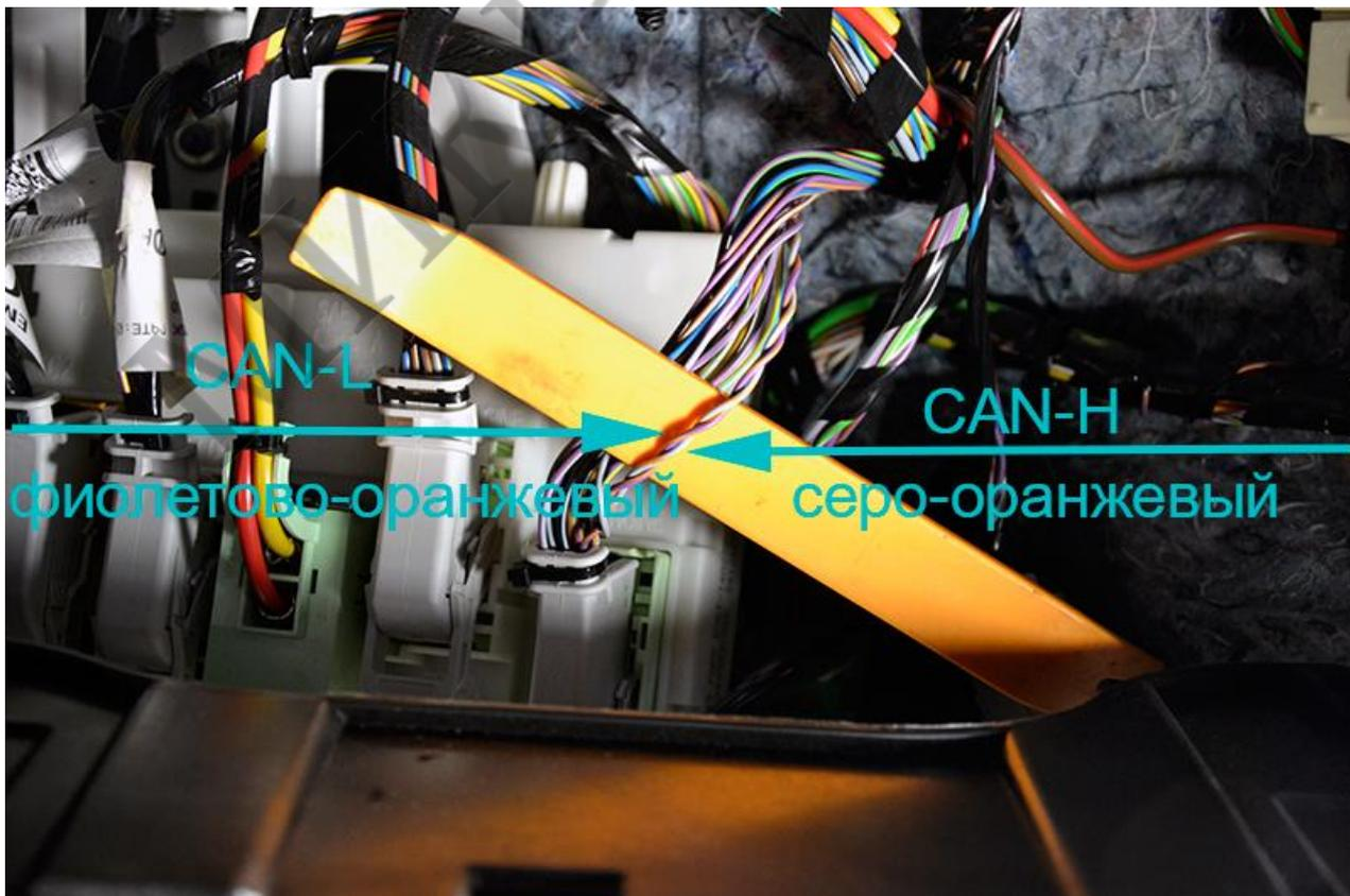
В этом же разъёме подключите провода аварийной сигнализации по силовой схеме от релейного блока. Сине-зелёный и жёлто-фиолетовый.
