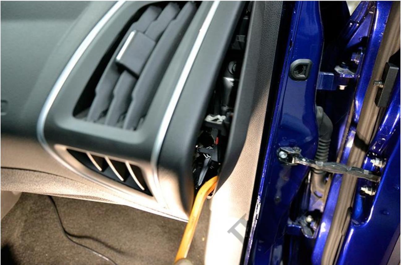
Снимите пластиковые гайки крепления текстильной накладки в ногах пассажира и снимите её.
