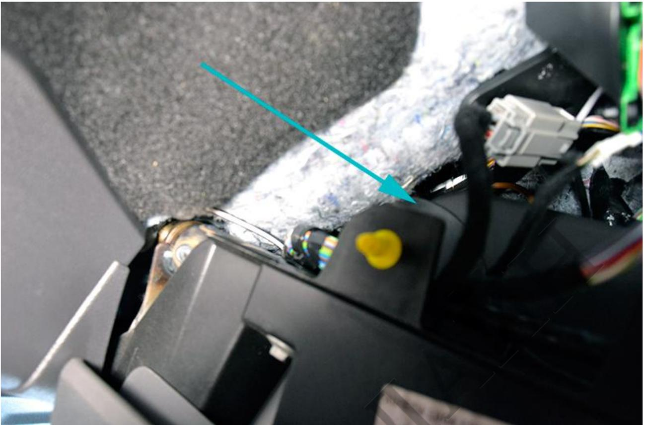
Выкрутите саморез крепления бардачка с торца панели.
