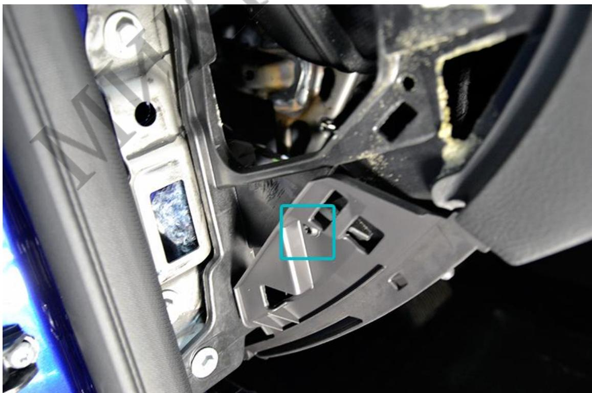
После чего снимите коленную накладку панели. Крепление на защёлках. Выкрутите винты крепления нижней части кожаного рулевого вала и снимите его.
