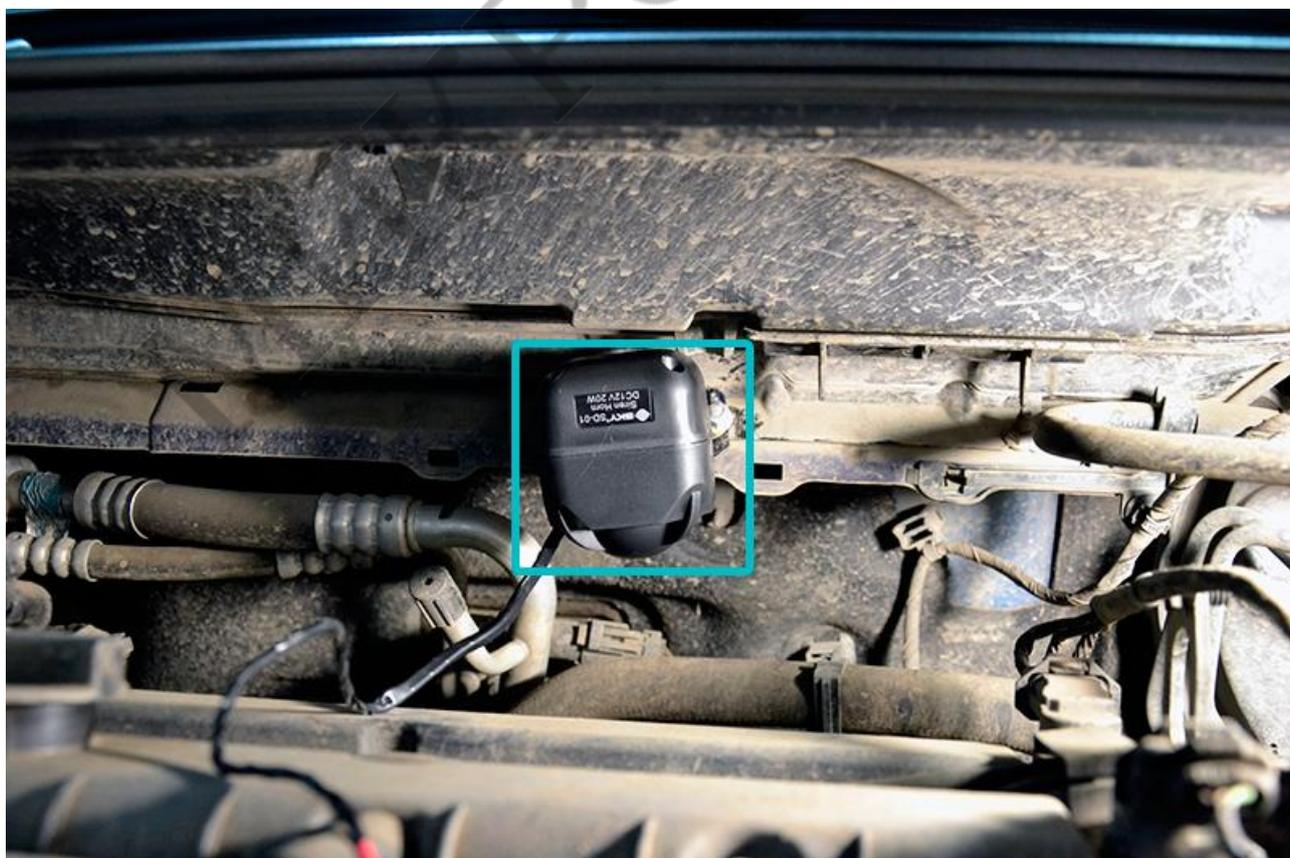
Установите датчик температуры двигателя. Возможное место установки.
