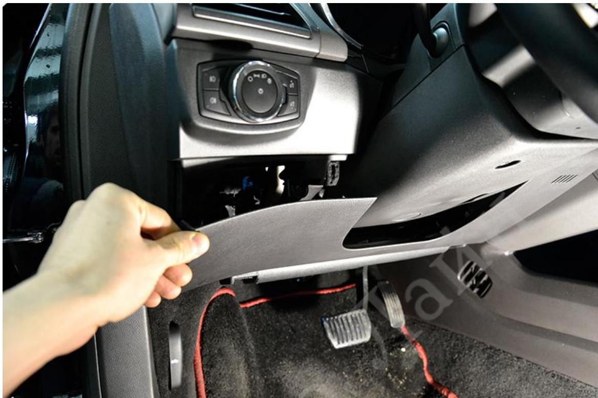
После чего открутите 2 самореза, держащих её и снимите, отодвинув в сторону, для удобства проведения последующих работ. Далее необходимо снять боковые накладке панели.
