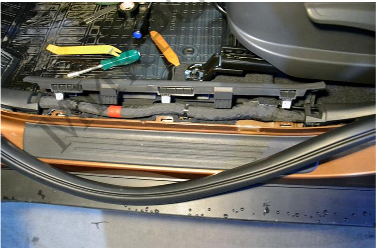
Снимите ручку открытия капота и после этого снимите водительскую кик-панель.
