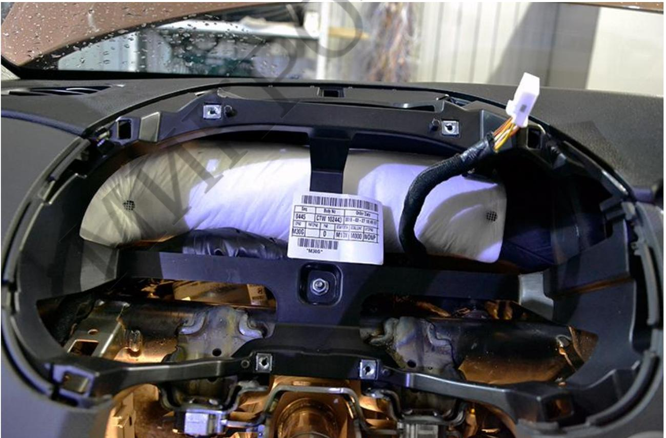
Разместите Центральный Блок сигнализации за щитком приборов. Подключите массу сигнализации под любой удобный болт или гайку на кузове автомобиля. CAN-шину сигнализации удобно подключить в большом разъёме щитка приборов. CAN-H – оранжевый, CAN-L – зелёный.
