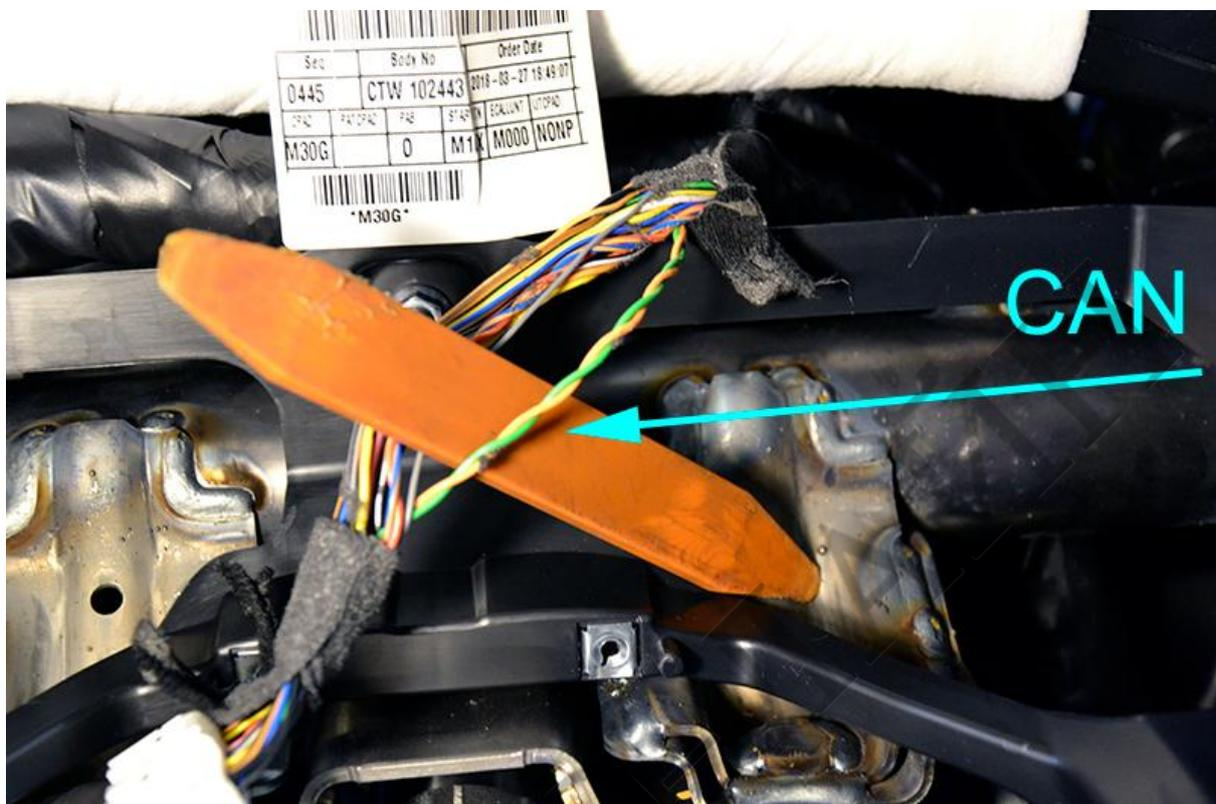
Так же можно подключить CAN шину в сером разъёме с тыльной стороны блока предохранителей.
