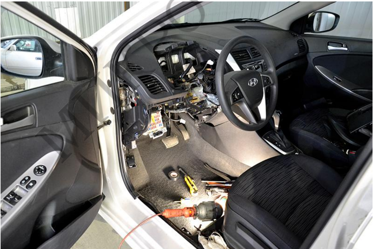
Закрепите Центральный Блок сигнализации в скрытом месте, надёжно прикрепив его к кузову автомобиля.
