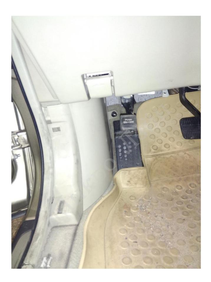
Снимаем приборную панель, для этого необходимо открутить 4 болта снизу панели. Размещаем блок сигнализации, а так же прикручиваем под штатный болт массу системы
