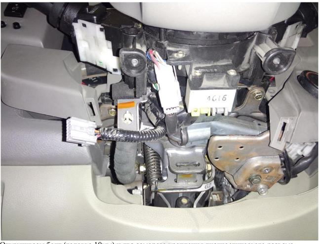
Откручиваем болт (головка 10мм) и два самореза крепления диагностического разъема и снимаем отщелкиваем накладку
