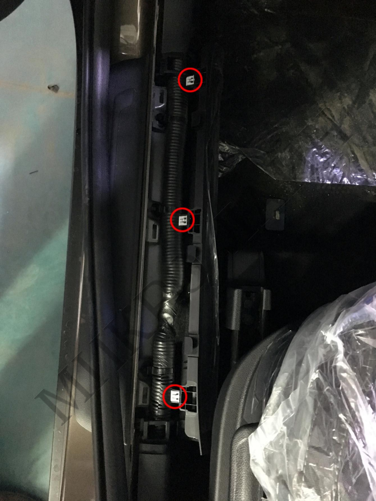
Снимаем накладку порога водительской кик-панели
