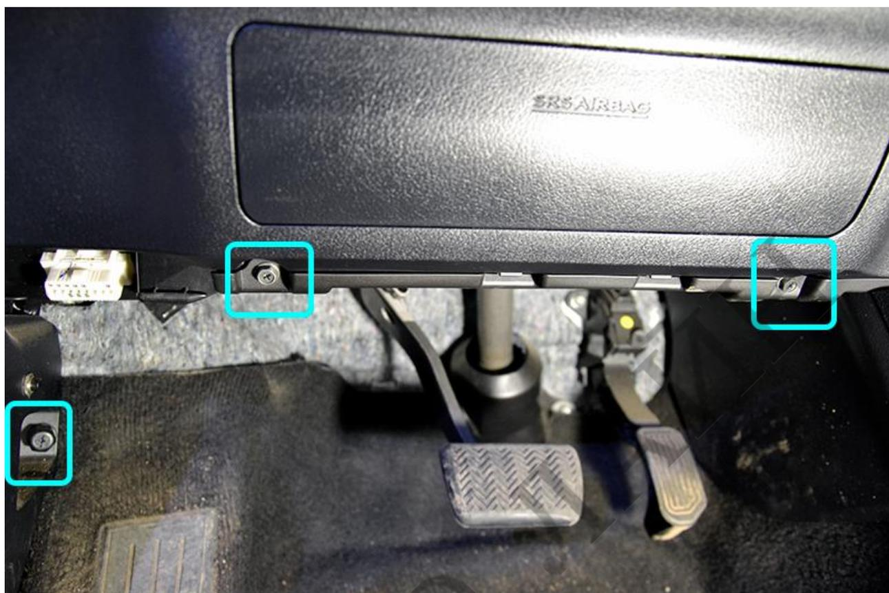
Снимите с защёлок накладку порога водителя и кик-панель водителя.
