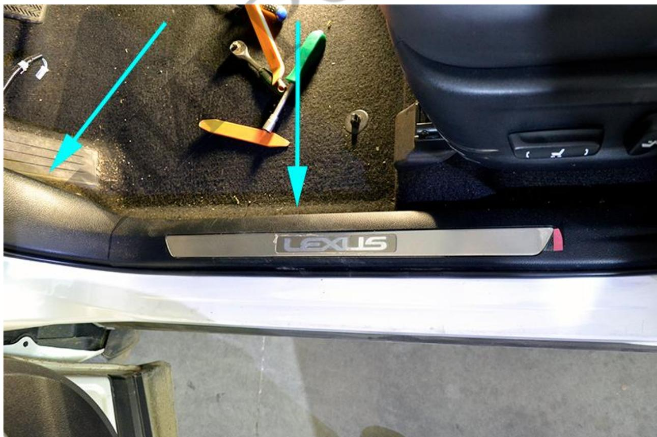
Кик-панель и порог сняты. Общий вид.
