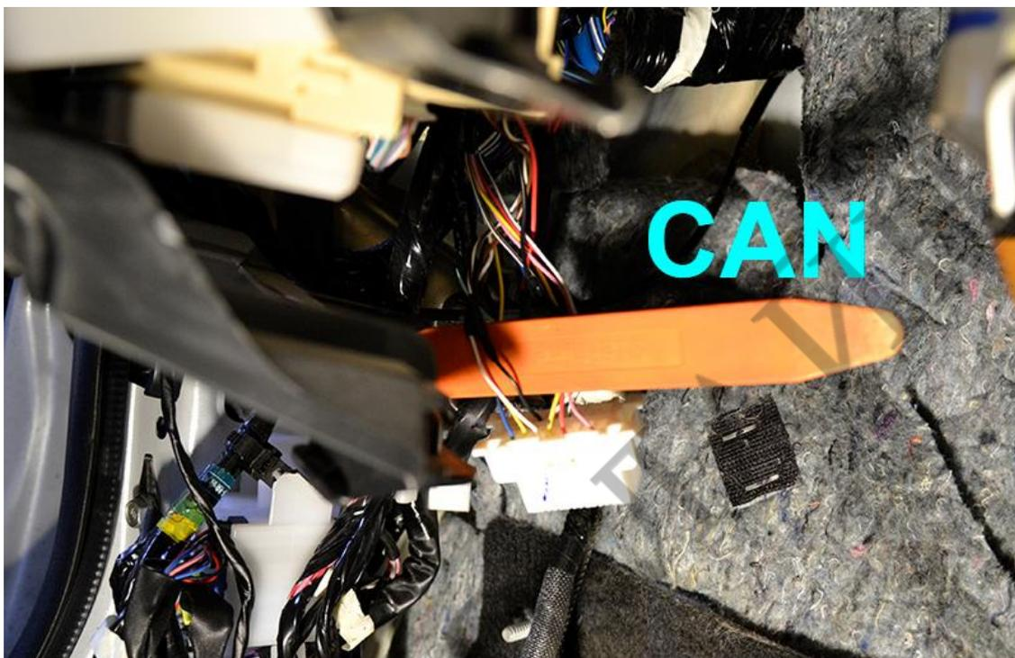
Подключите массу, питание, зажигание и сигнал SLP (при использовании алгоритмического обходчика иммобилайзера) на разъёме защёлки рулевого вала.
