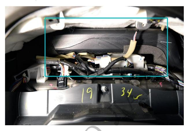
Проложить провода под капот можно через штатный уплотнитель за блоком предохранителей.
