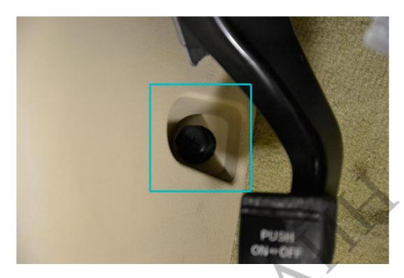
Снимите торцевую накладку панели приборов. На защёлках.
