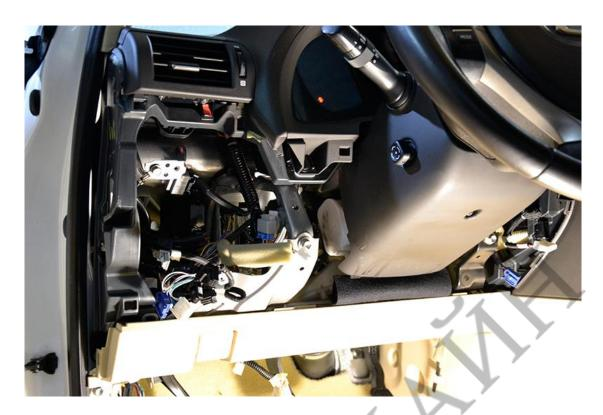
Открутите четыре болта крепления коленной подушки безопасности водителя и снимите её, отключив электрические разъёмы. Снимите ручку открытия капота.
