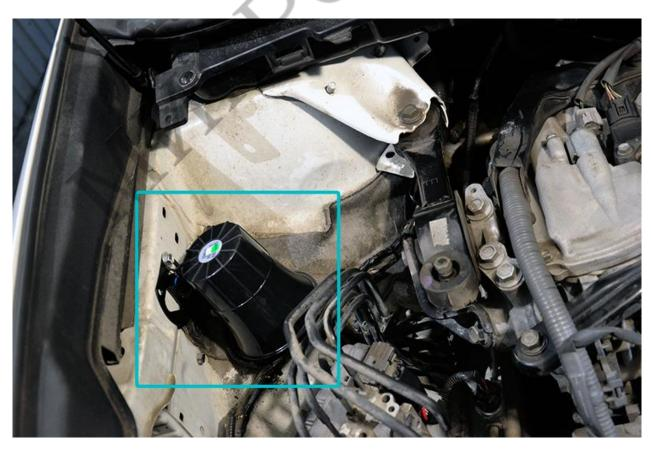
Возможное место установки датчика температуры двигателя:
