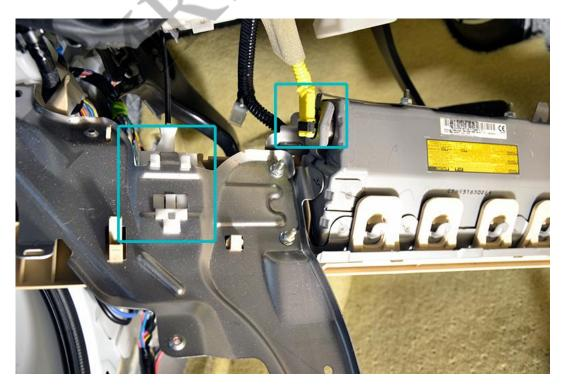
Для снятия щитка приборов отщёлкните кожаный пыльник от кожуха рулевого вала.
