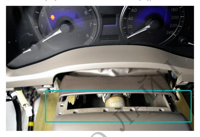
Извлеките заглушки в верхней части козырька щитка приборов и выщелкните клипсы крепления.
