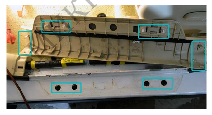
После чего открутите пластиковую гайку крепления кик-панели и снимите её.
