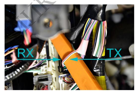
На разъёме замка руля подключите провод SLP и Зажигание алгоритмического обходчика. SLP – зелёный.
