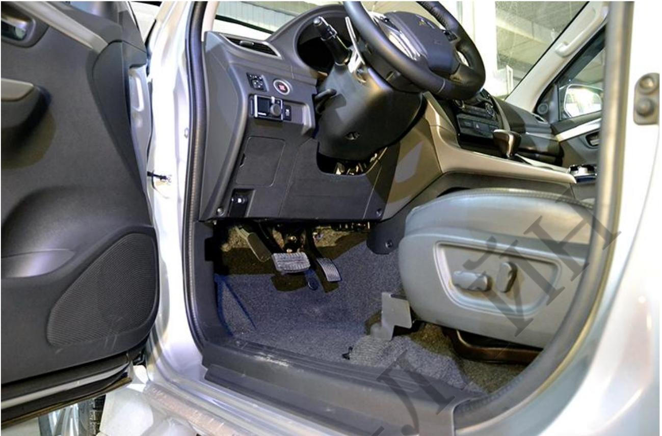
Снимите накладку в ногах водителя, отщёлкнув три клипсы крепления.
