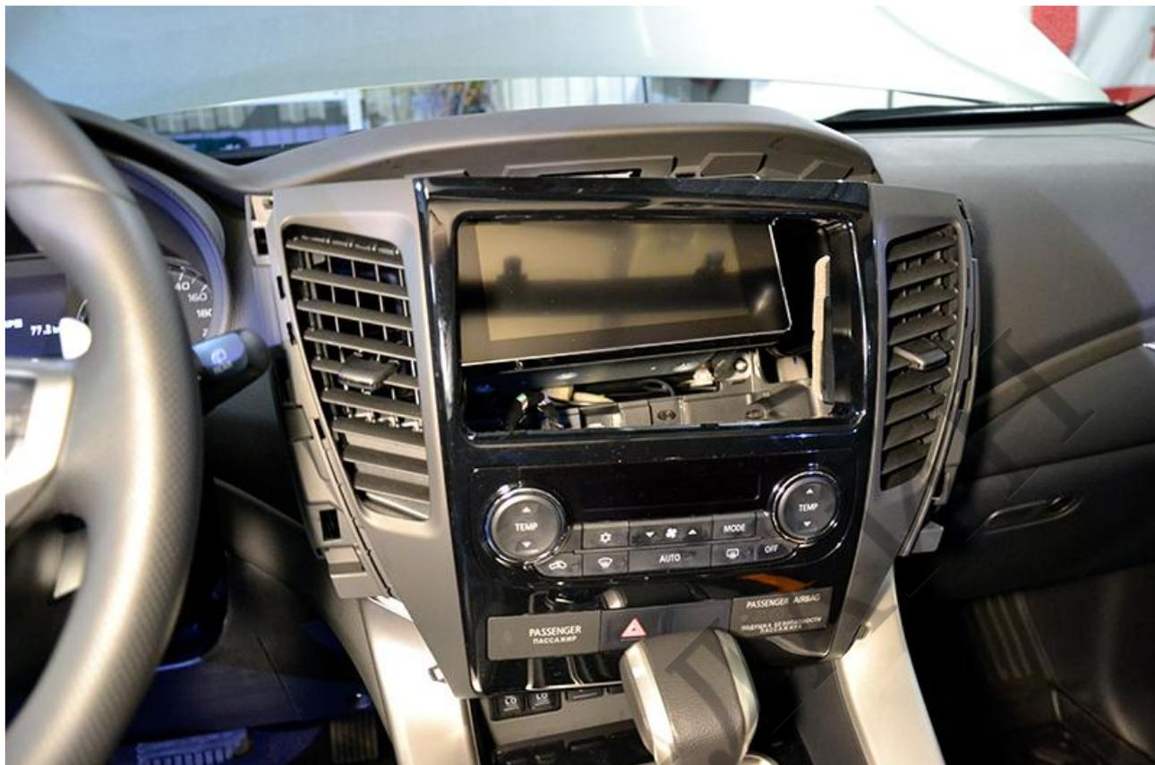
Снимите накладку щитка приборов.
