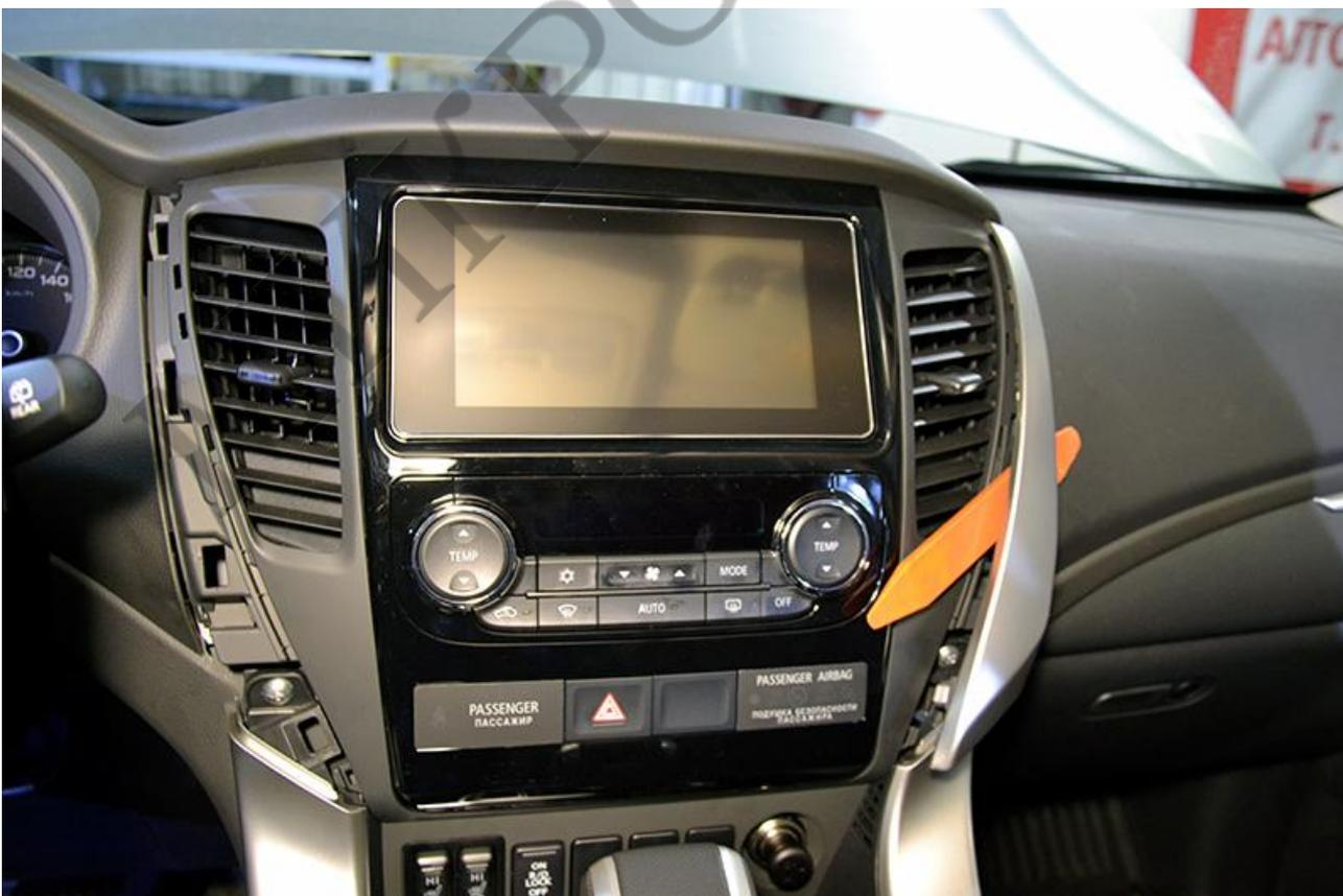
Снимите панель климат-контроля. На защёлках.
