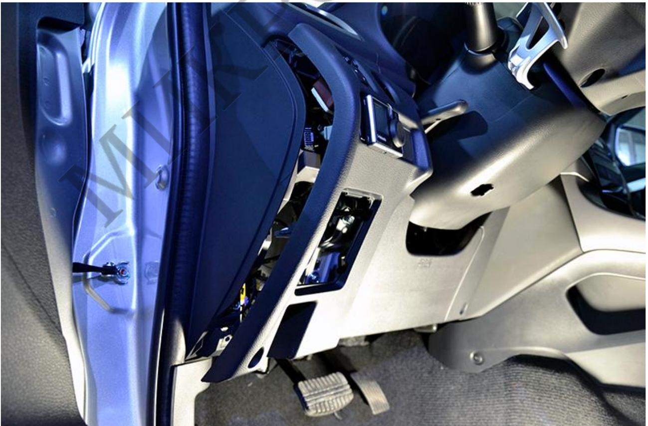
Снимите накладку порога водителя. На защёлках.
