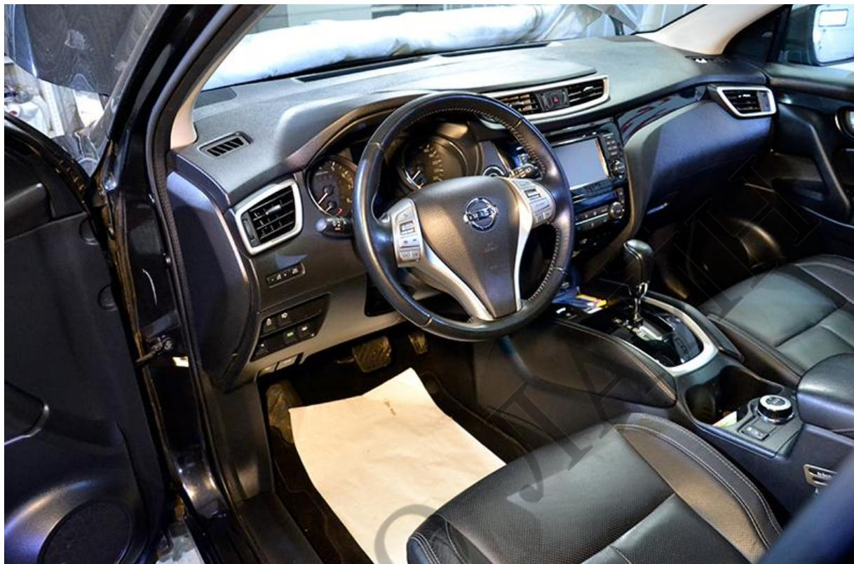
Снимите накладку с торца панели. На защёлках.
