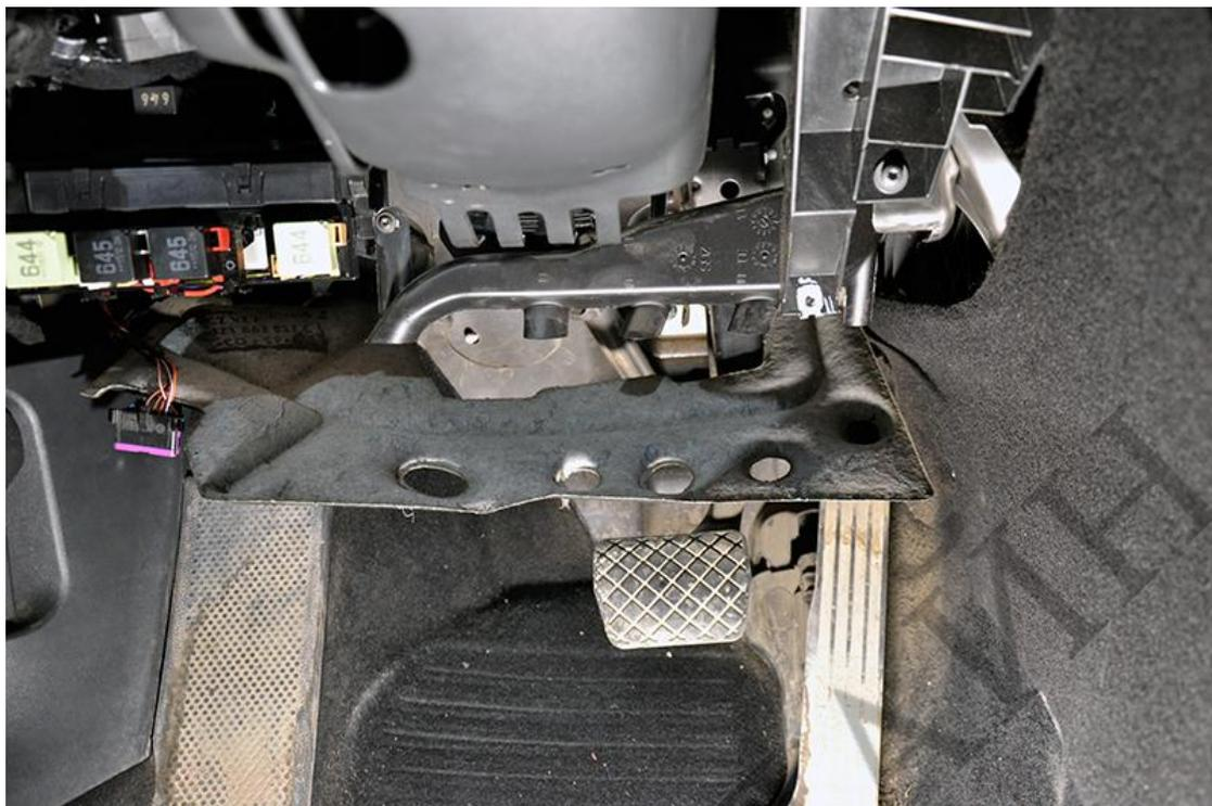
Основные подключения выполняются в жгуте коричневого разъёма блока BCM.
