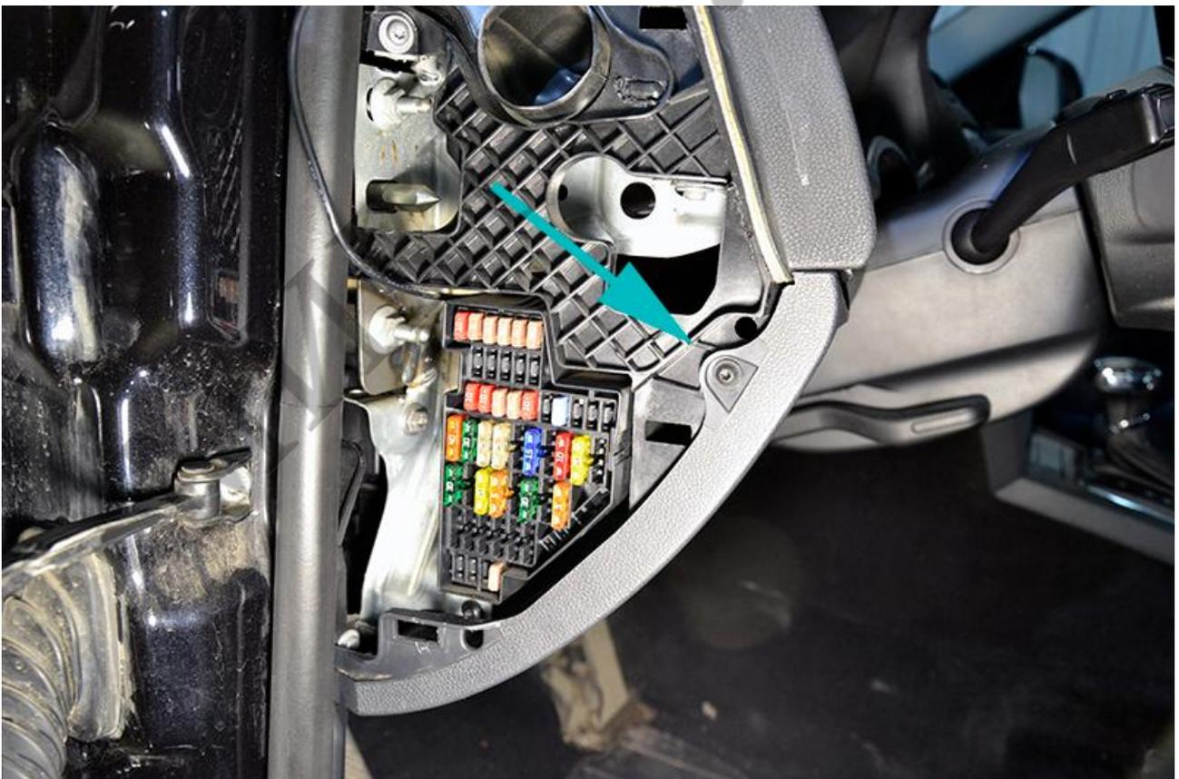
Теперь можно снять коленный буфер потянув его на себя и высвободив разъем OBD II из крепления (на защёлках).
