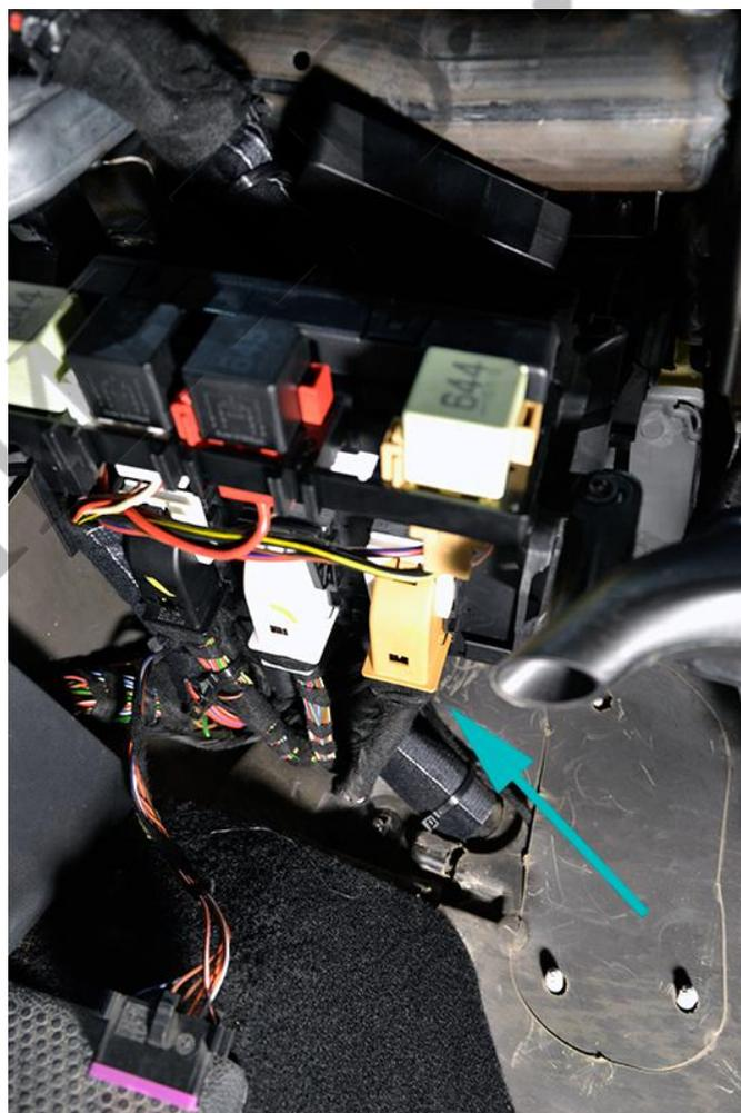
Для подключения цепей автозапуска необходимо снять кожух рулевого вала.
