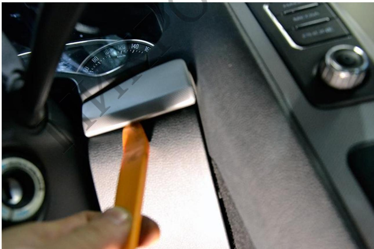
За снятыми накладками открутить два самореза крепления коленного буфера водителя.
