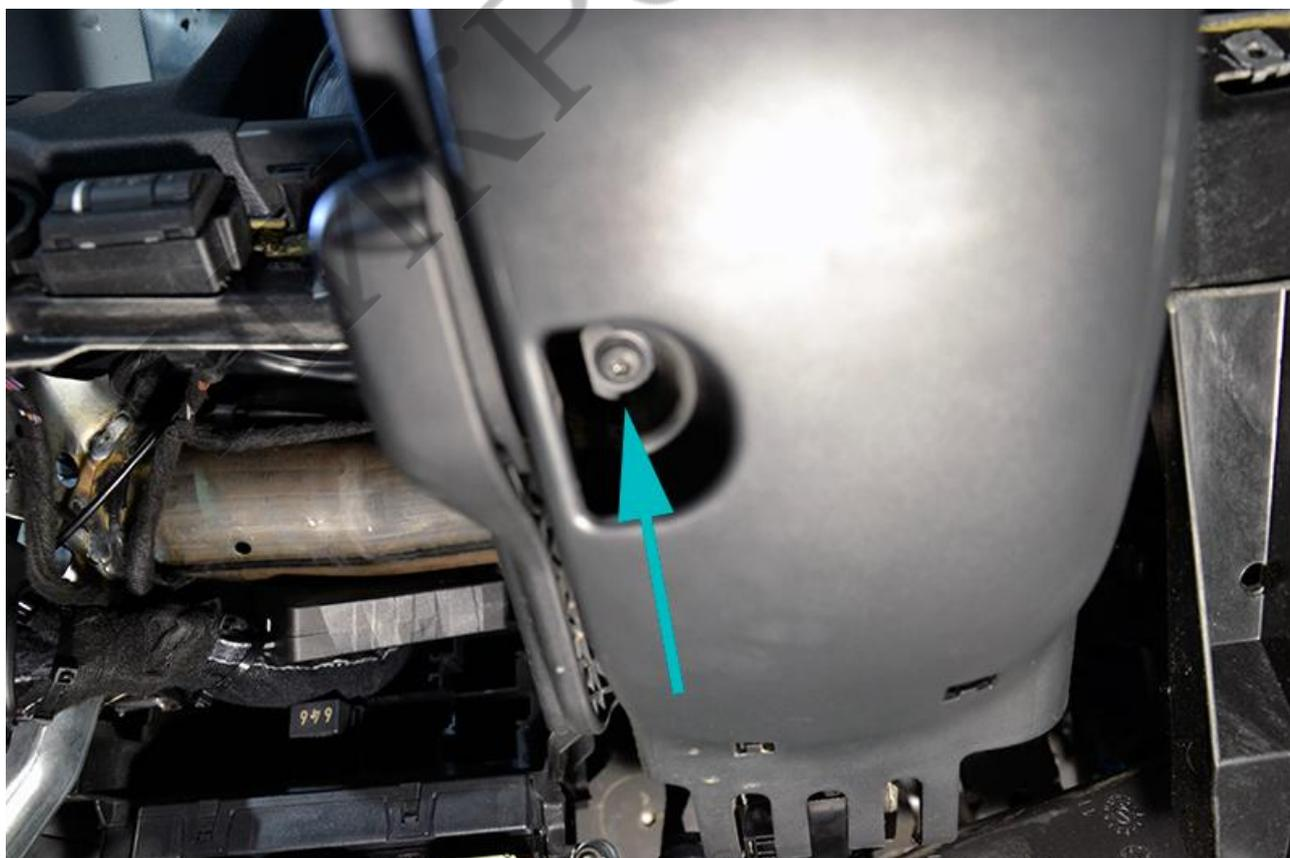
Выкрутите болты слева и справа в торцах кожуха и снимите его нижнюю часть.
