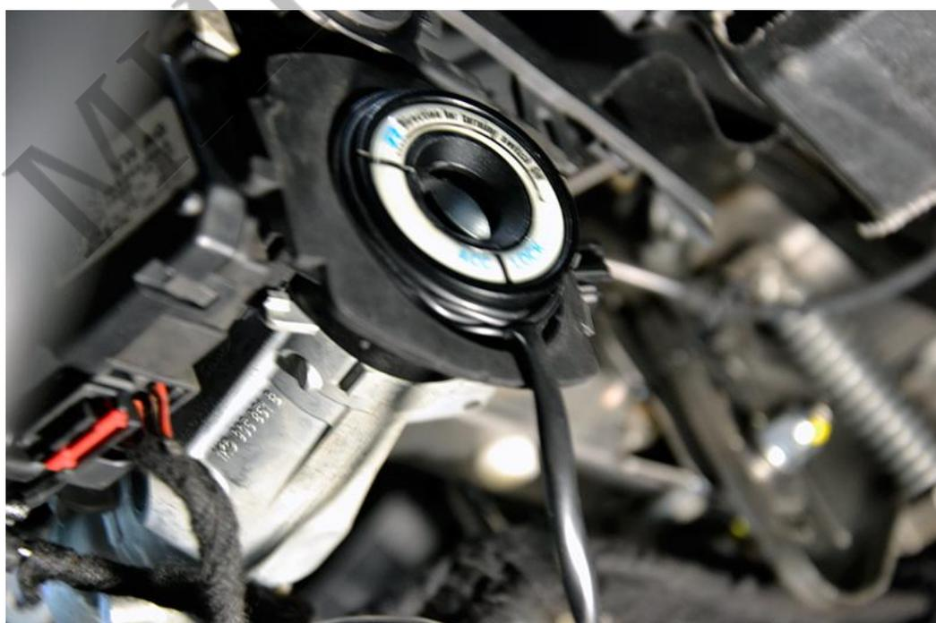
Для прокладки проводов под капот можно использовать штатный уплотнитель, либо заглушку педали сцепления на автомобилях с АКПП.
