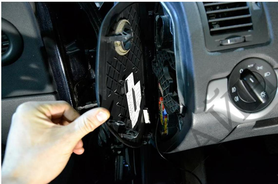
Далее выньте переключатель света (ЛКМ) и отключите его электрический разъём. Для этого нужно переключить переключатель в режим 0, нажать на его ручку и в нажатом состоянии начать поворачивать его в сторону Auto примерно до положения, как на фотографии ниже, после чего можно вытянуть переключатель на себя.
