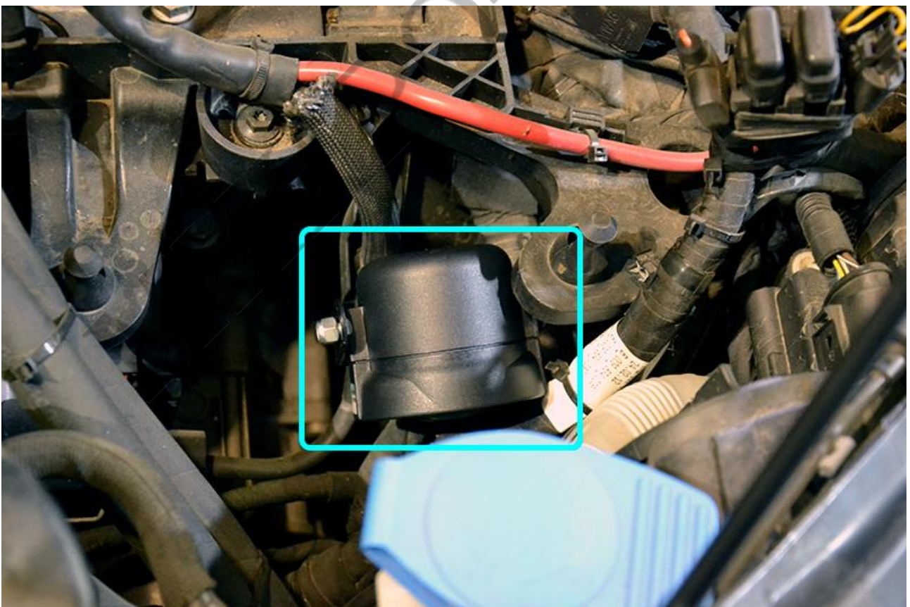
Датчик температуры двигателя закрепите хомутами на патрубке охлаждающей жидкости или корпусе термостата.
