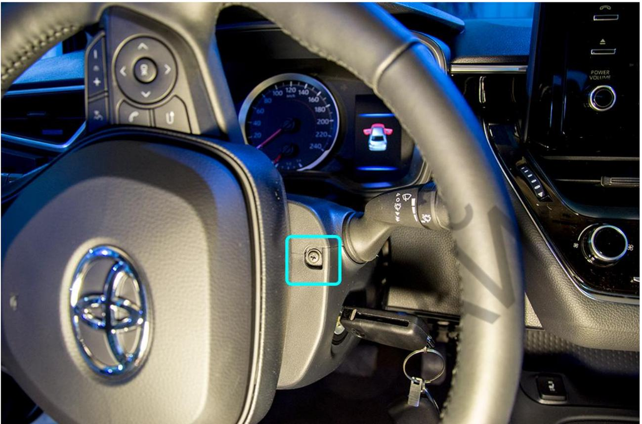
Снимите накладку щитка приборов. На защёлках.
