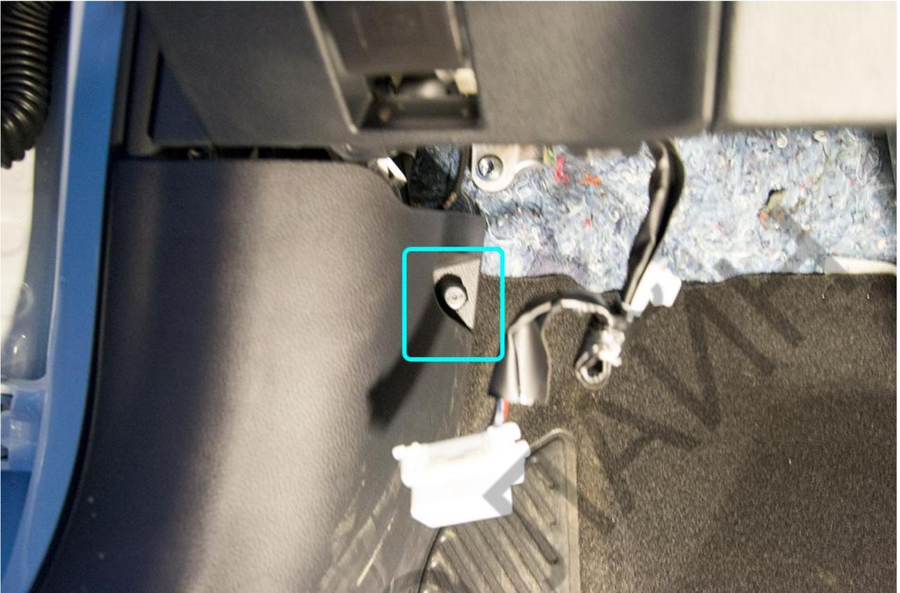
Снимите боковую накладку панели. На защёлках.
