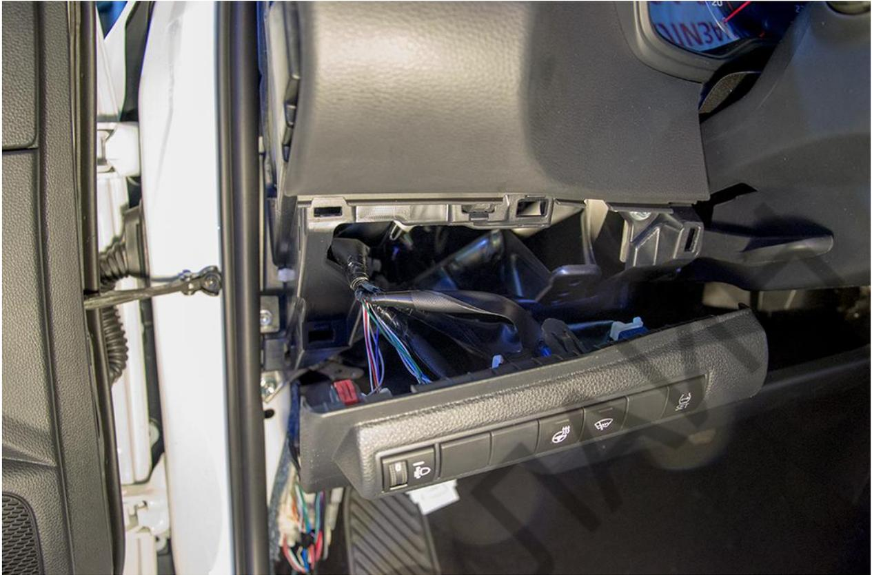
На автомобилях без ножной подушки безопасности нужно снять всю нижнюю накладку одним элементом.
