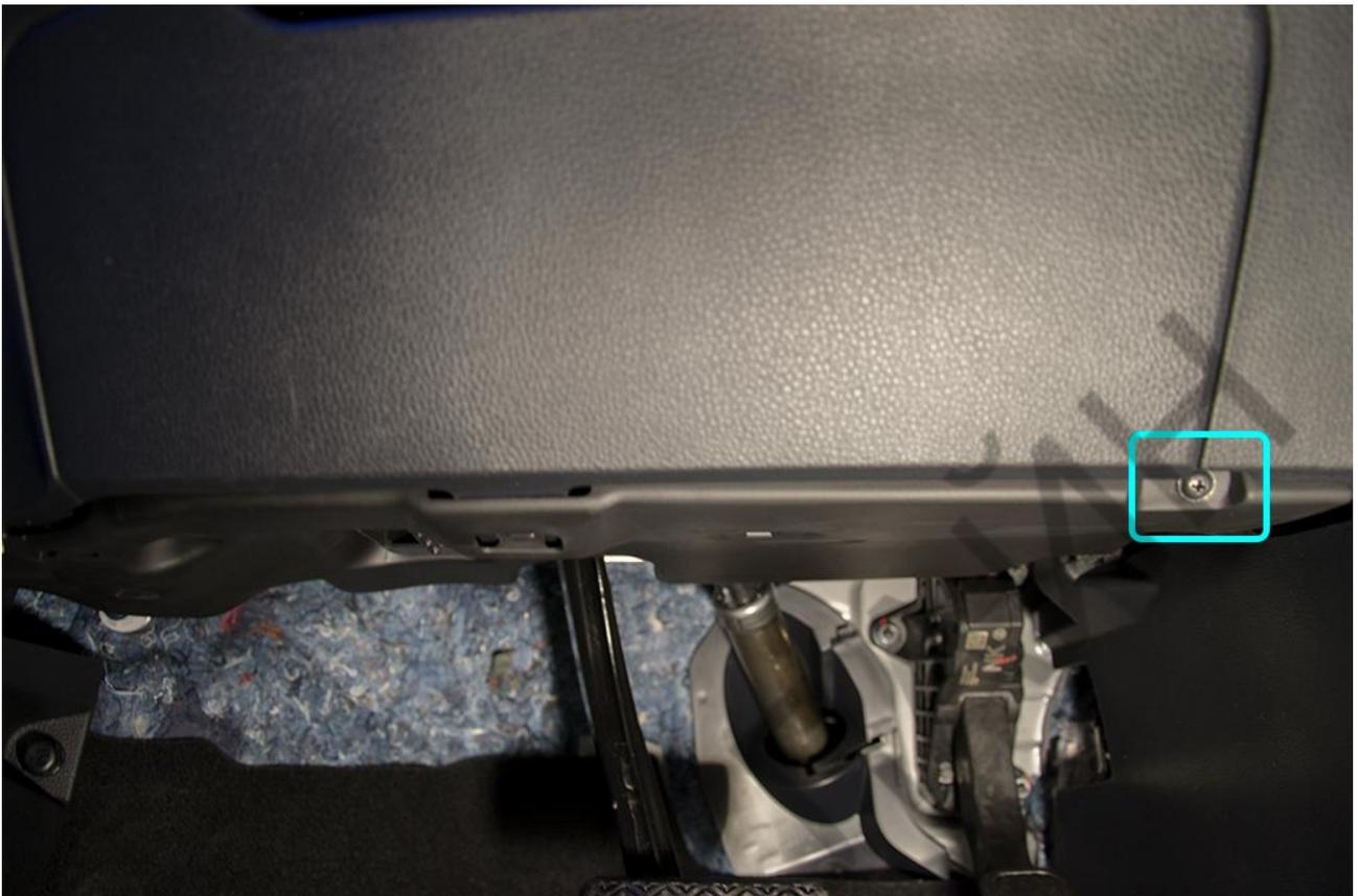
Снимите накладку водительского порога. На защёлках.
