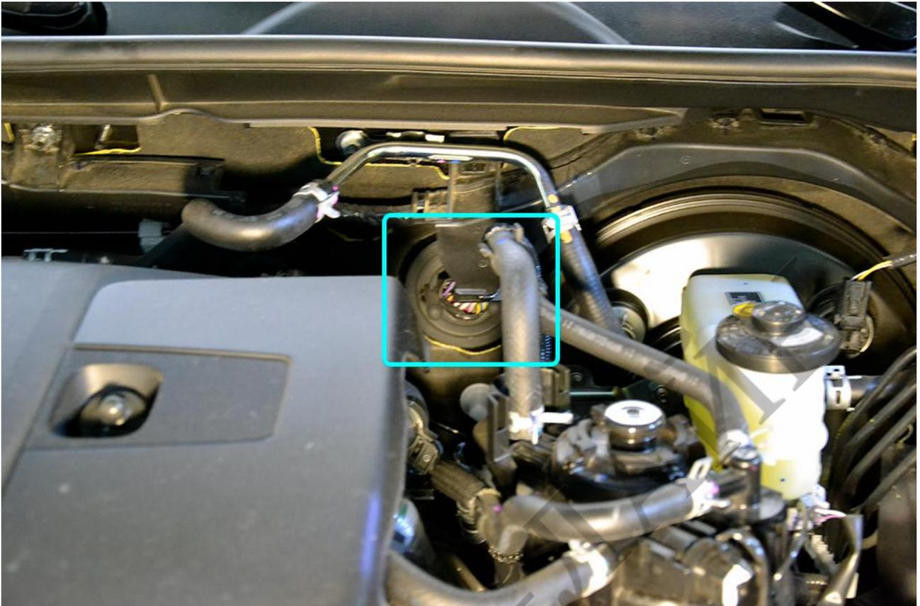
Возможное место установки сирены. Возможно закрепить датчик температуры двигателя пластиковыми стяжками-хомутами на патрубках малого круга ОЖ рядом с сиреной.
