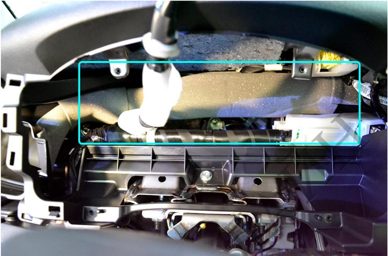
Подключите массу сигнализации в любое удобное место под штатный болт или гайку на кузове автомобиля. Подключите CAN-шину сигнализации в жгуте разъёма диагностики. CAN-H – синий. CAN-L – белый.
