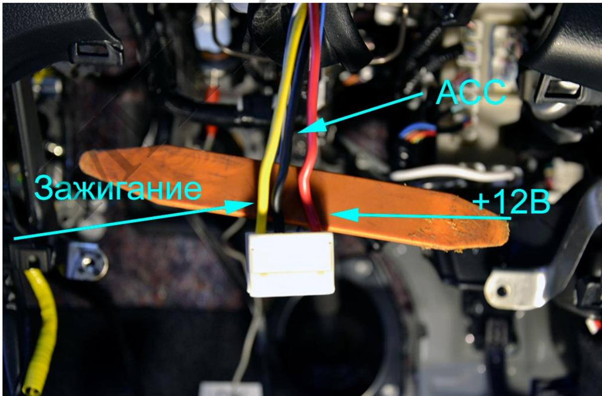
Для автомобилей с АКПП подключите Жёлто-Чёрный провод Релейного Модуля к Синему проводу на замке зажигания.
