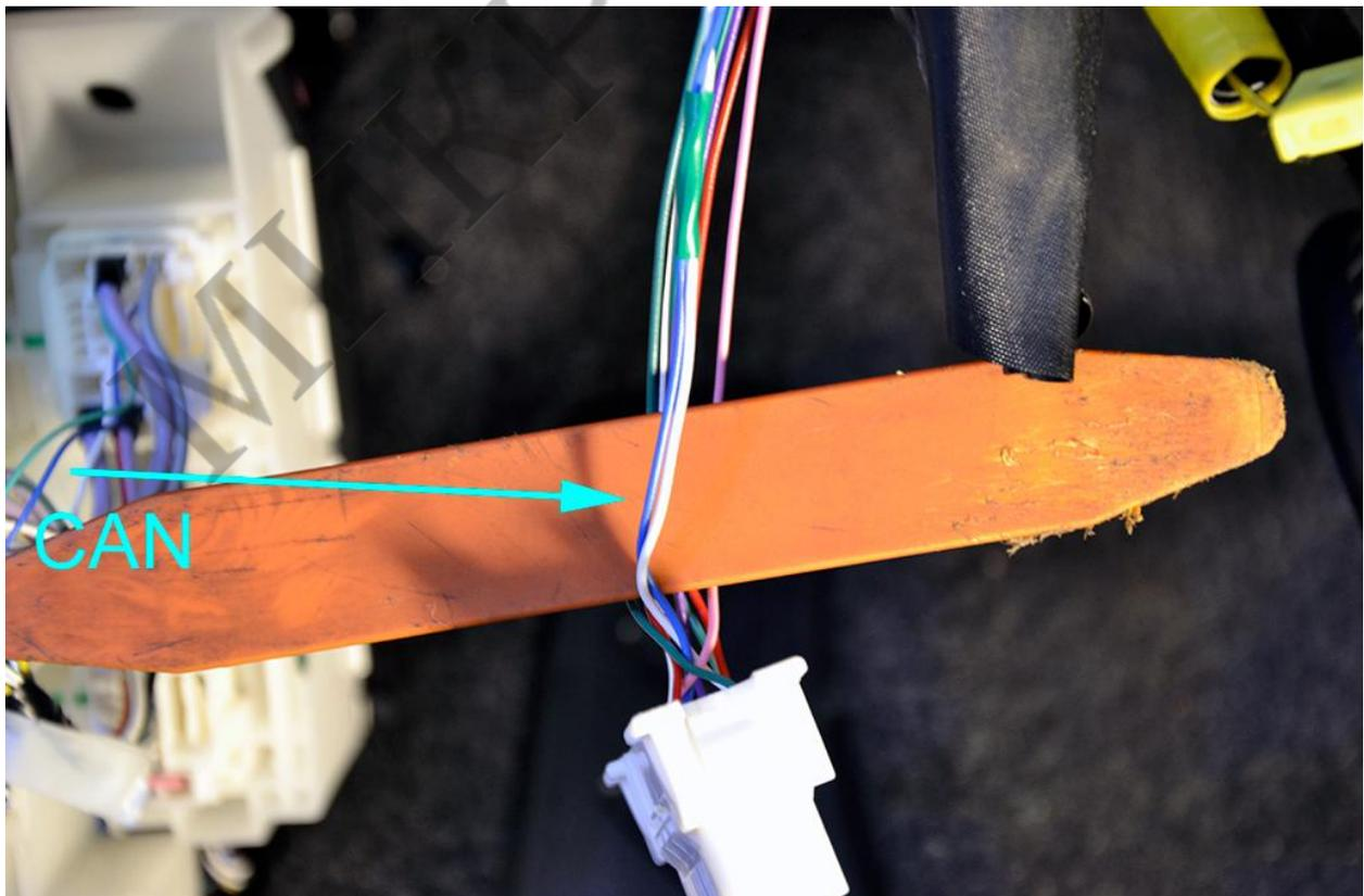
Для управления Центральным Замком подключите Оранжево-Чёрный провод Центрального Блока к Зелёному проводу в жгуте разъёма из двери водителя в левой кик-панели, Оранжевый провод Центрального Блока к Синему проводу в этом же жгуте.
