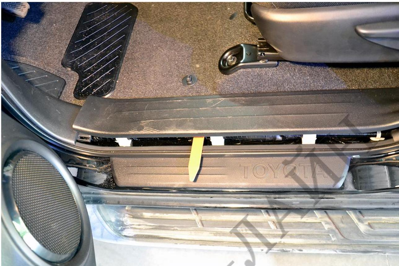
Открутите пластиковую гайку крепления кик-панели водителя и снимите её.
