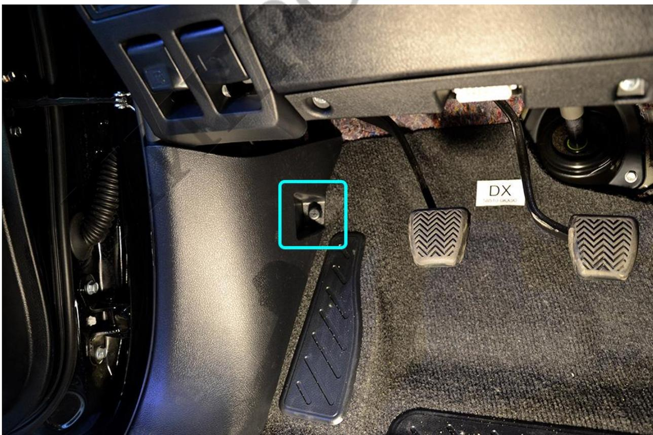
Выкрутите саморезы крепления накладки с диагностическим разъёмом и снимите её.
