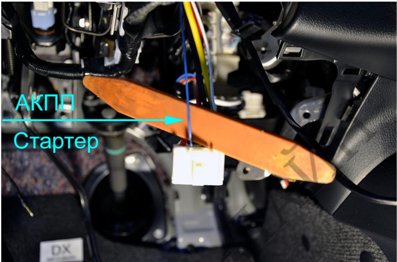
Для автомобилей с МКПП подключите Жёлто-Чёрный провод Релейного Модуля к Зелёному проводу на нижнем конце педали сцепления.
