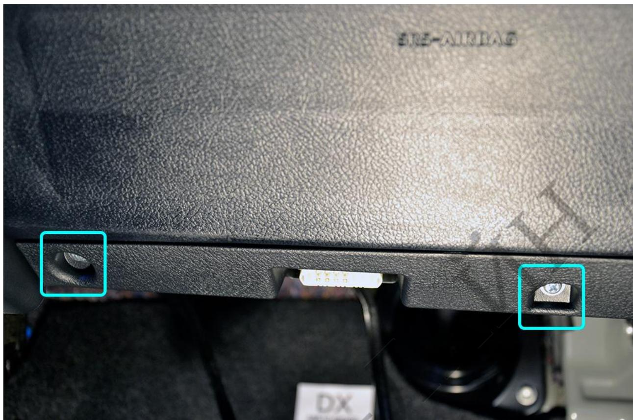
Выкрутите болты крепления коленной подушки SRS AIRBAG.
