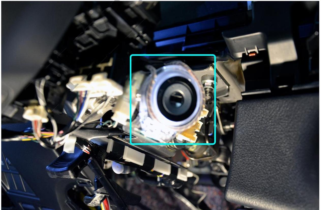
Подключите цепи зажигания и питания в жгуте замка зажигания.
