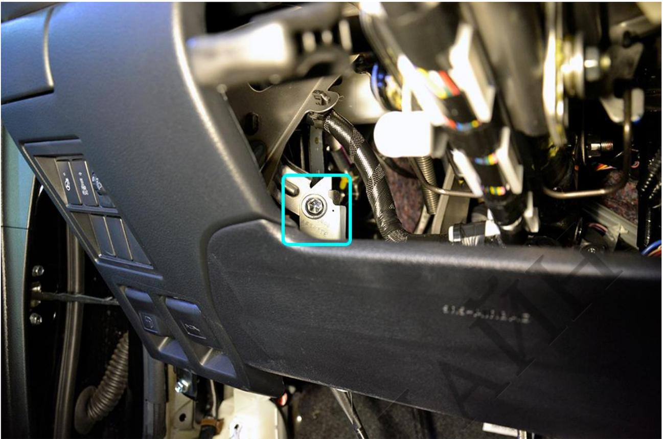
**ВНИМАНИЕ!** Отключение и обратное подключение подушки производить только при выключенном зажигании и вынутым из замка зажигания ключе!
