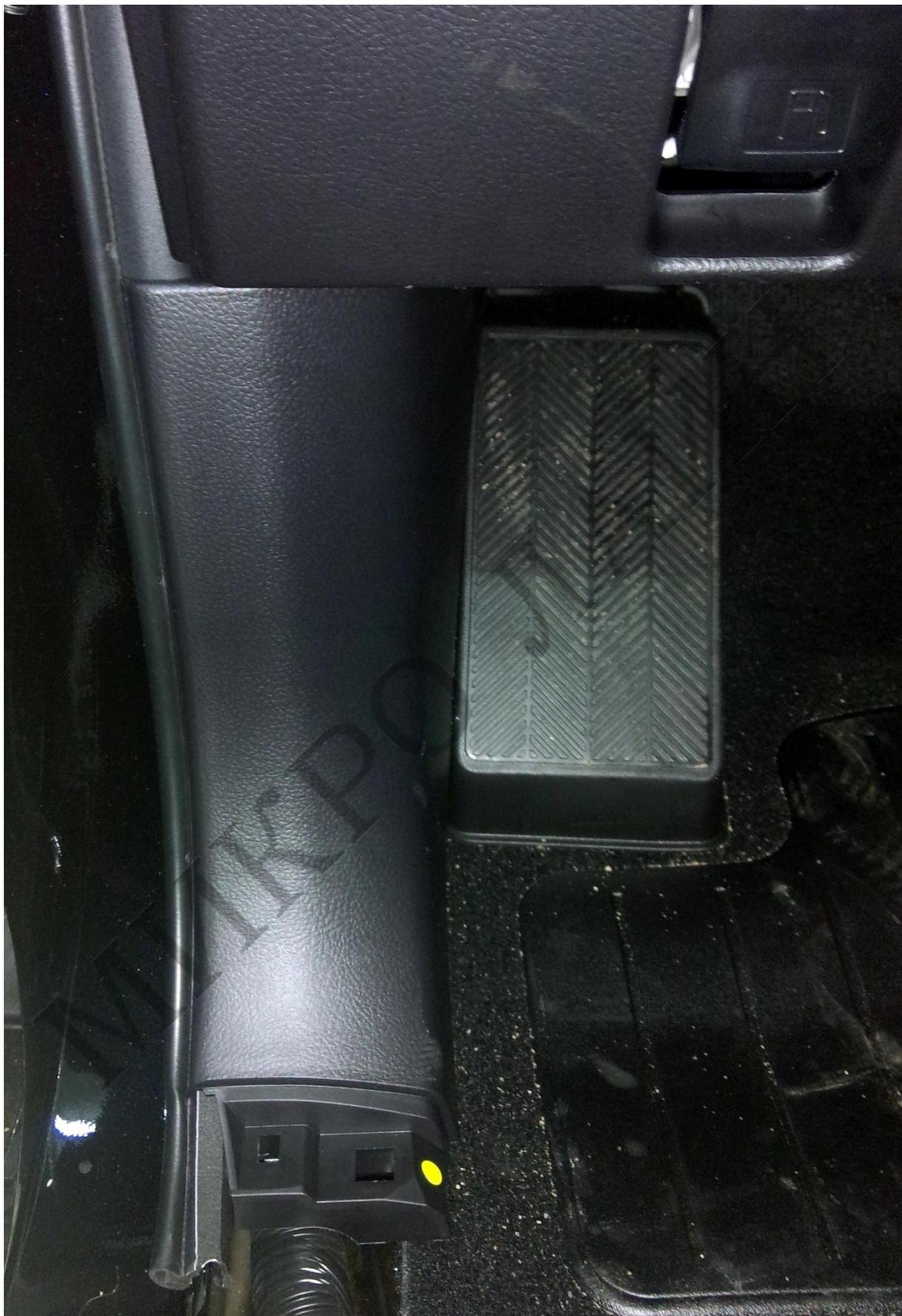
Снимаем декоративную накладку
