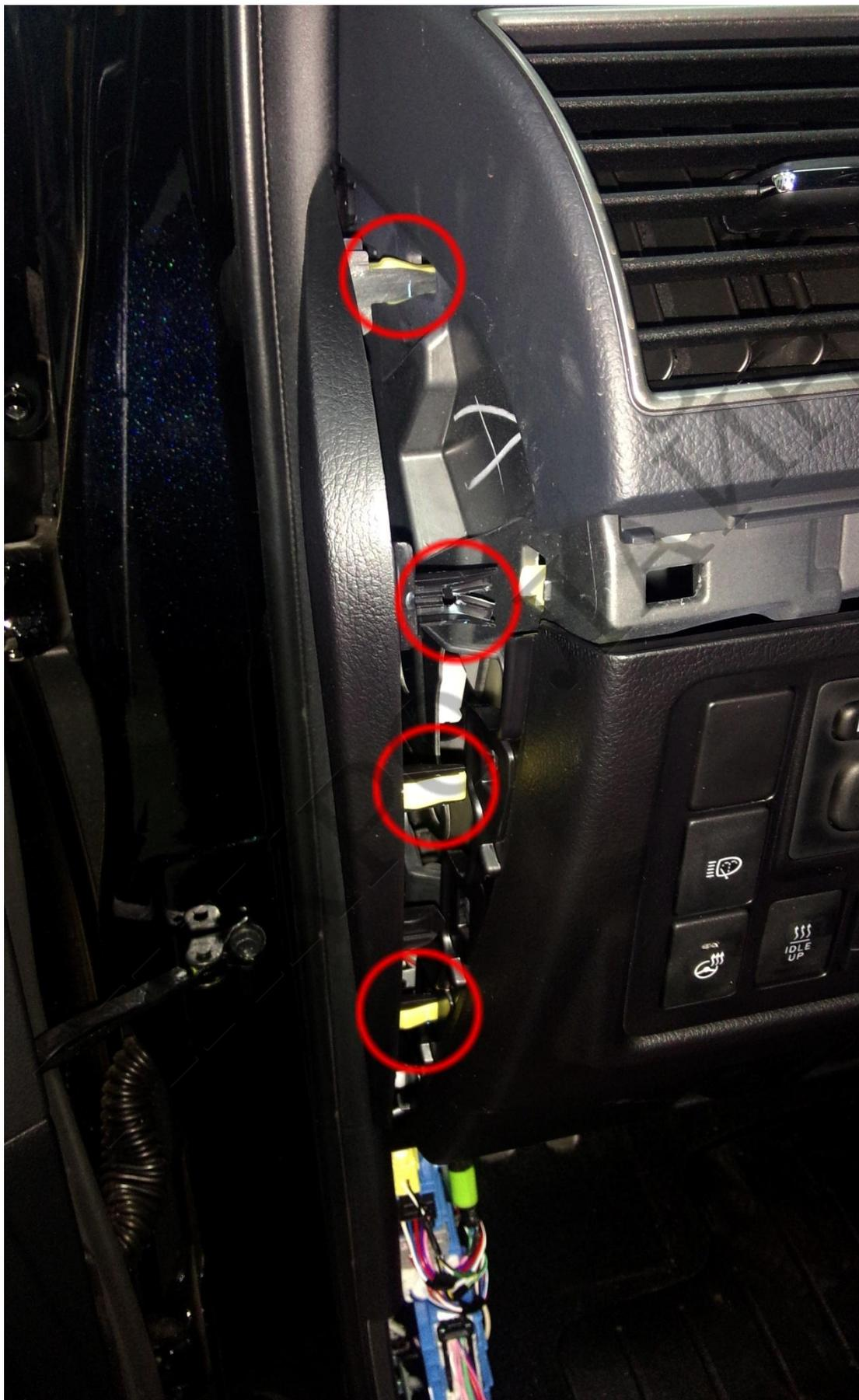
Отворачиваем саморез, отщелкиваем защелки и снимаем накладку.
