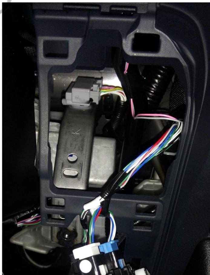
Снимаем накладку приборной панели
