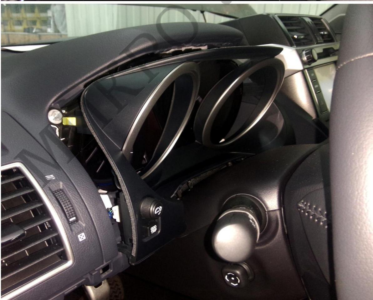
Откручиваем приборную панель
