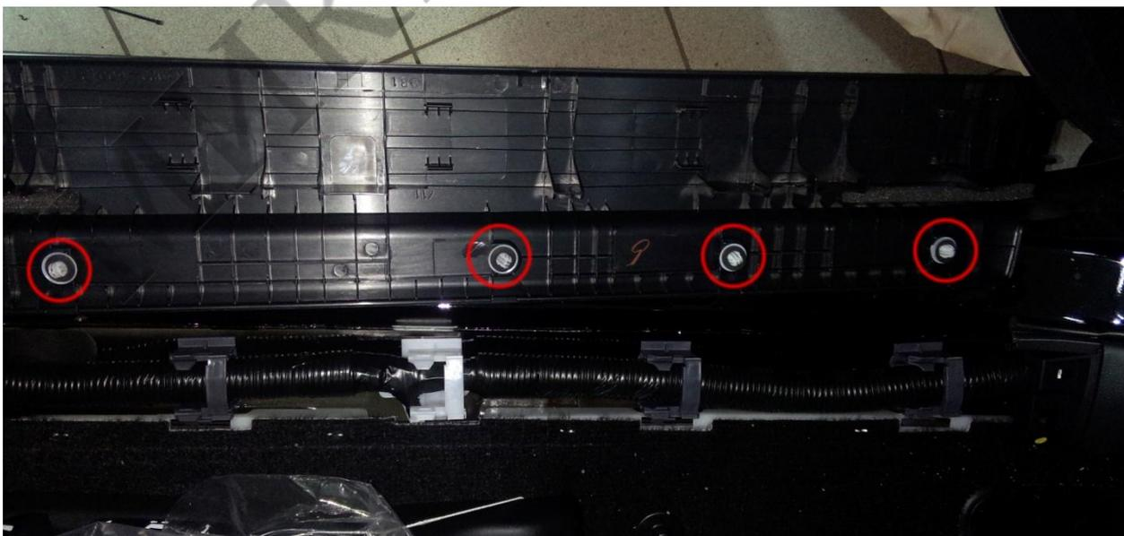
Снимаем пластиковый упор для ноги и пластиковую накладку кик-панели
