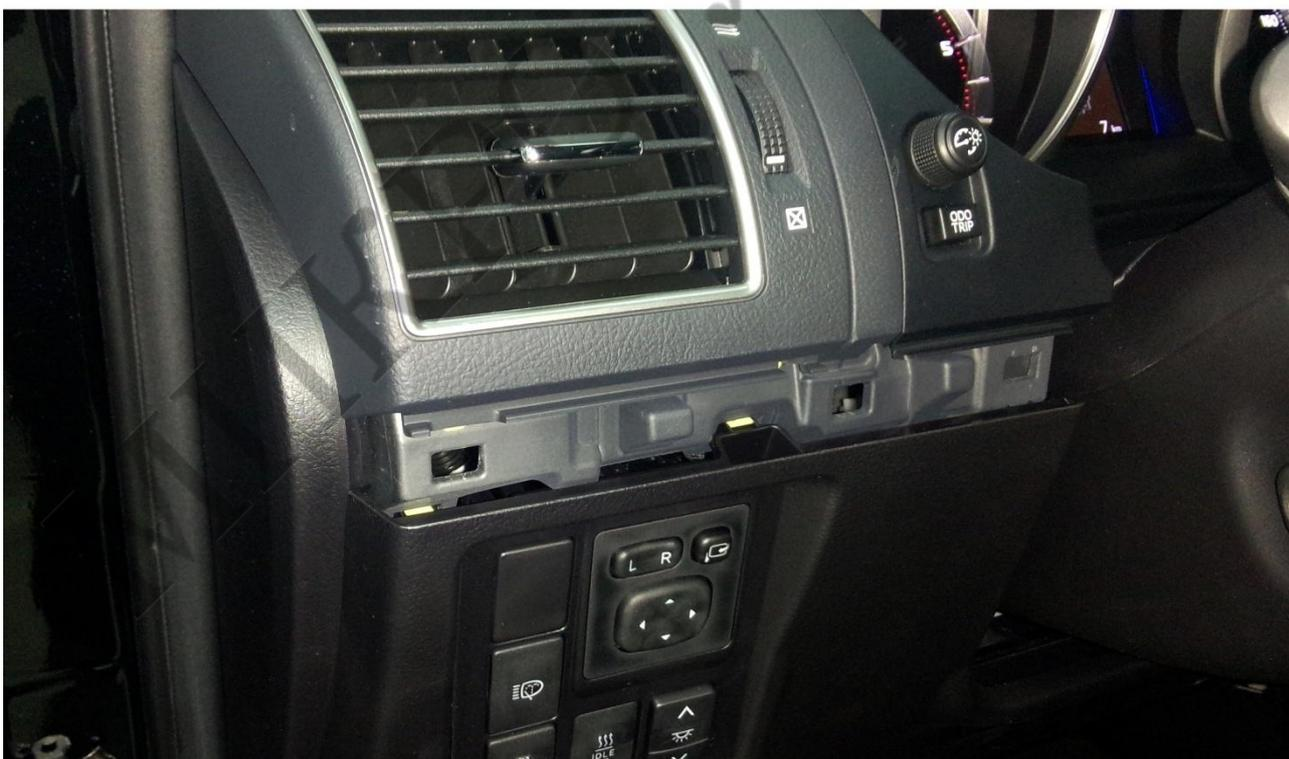
Снимаем боковую накладку
