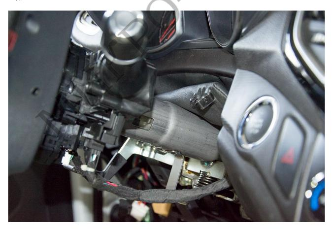
Отщёлкните крепление пыльника рулевого вала со стороны щитка приборов. Выкрутите два самореза крепления щитка приборов.
