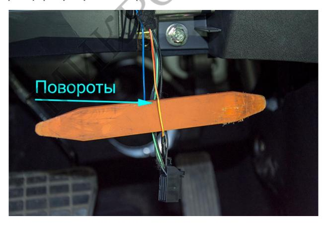
Для имитации нажатия педали тормоза подключите Жёлтый провод **Релейного Модуля** сигнализации к *Красно-Чёрному* проводу на разъёме концевика педали тормоза.
