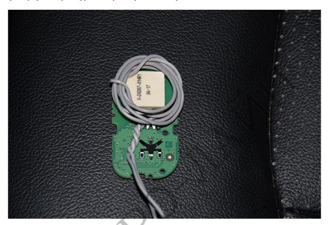
Подключите *Оранжево-Жёлтый* и *Оранжево-Зелёный* провода **Релейного модуля** в разрыв любого из проводов антенный штатного иммобилайзера. Подключите самодельную антенну на плате ключа к *Оранжево-Зелёному* и *Оранжево-Чёрному* проводам **Релейного Модуля.** Более подробно смотрите на общей схеме подключений на странице 17.
