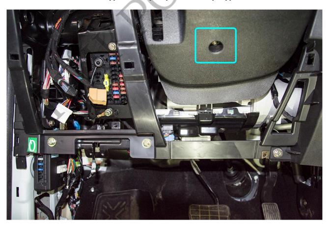
Для облегчения доступа к жгутам кнопки Старт-Стоп и Аварийной сигнализации снимите кожух рулевого вала. Для этого выкрутите так же саморезы крепления в торцах кожуха. Снимите пыльник кожуха рулевого вала. На защёлках.
