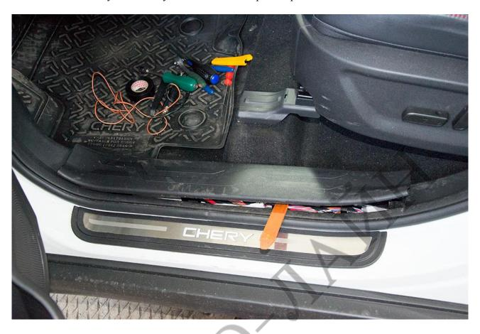
Открутите гайку крепления кик-панели водителя и снимите её.
