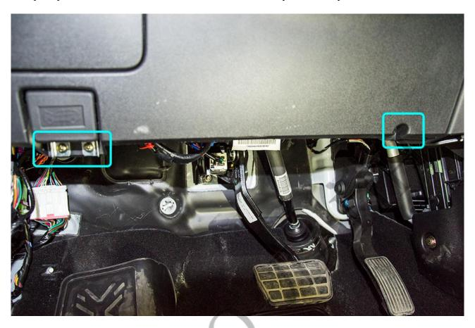
Коленная накладка снята. Выкрутите саморез крепления кожуха рулевого вала.
