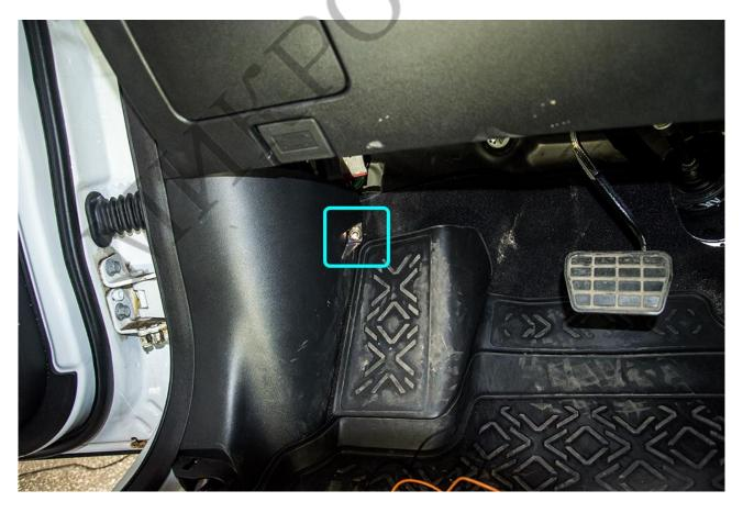
Снимите торцевую накладку панели.
