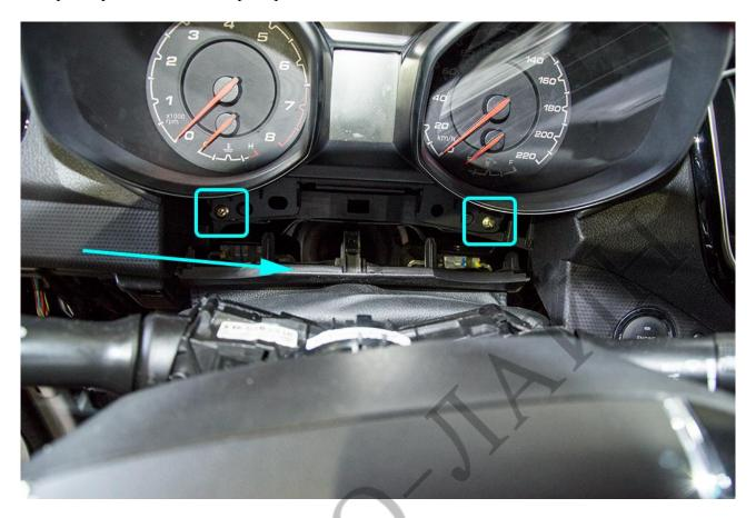
Снимите щиток приборов. Отключите электрический разъём.
