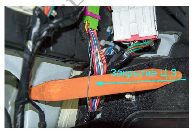
Оставшийся *Оранжево-Чёрный* провод со стороны **входа Релейного Модуля** подключите к *Жёлтому* проводу **Центрального Блока** сигнализации для использования Реле Запирания в качестве обходчика штатного иммобилайзера. Разберите штатный ключ и извлеките из него элемент питания. Изготовьте антенну из 6-7 витков тонкого провода, как показано на фотографии. Зафиксируйте получившуюся антенну на плате ключа.
