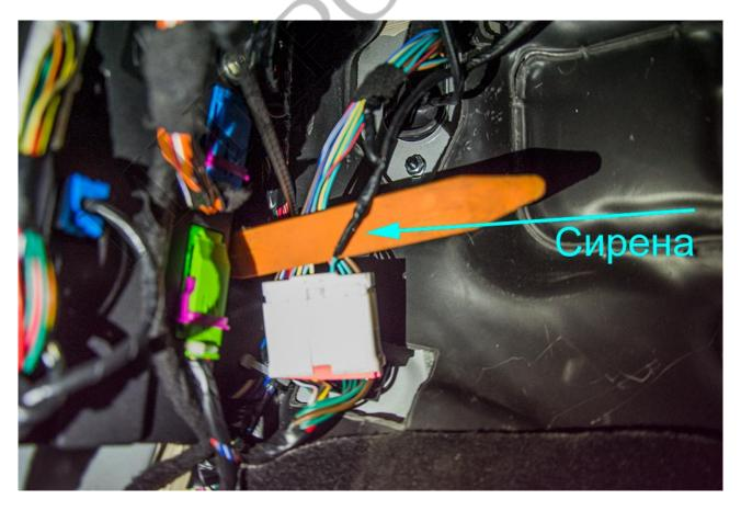
Отрежьте провод управления штатной сирены и подключите к концу провода, уходящему в сторону сирены под капот, *Жёлто-Красный* провод **Релейного Модуля** сигнализации.
