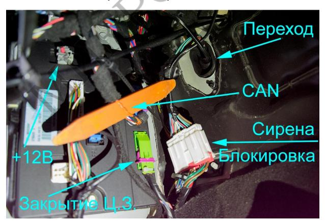
Подключить CAN-шину сигнализации возможно в жгуте синего разъёма блока BCM. **CAN-H** – оранжевый (pin15), **CAN-L** – оранжево-чёрный (pin14).
