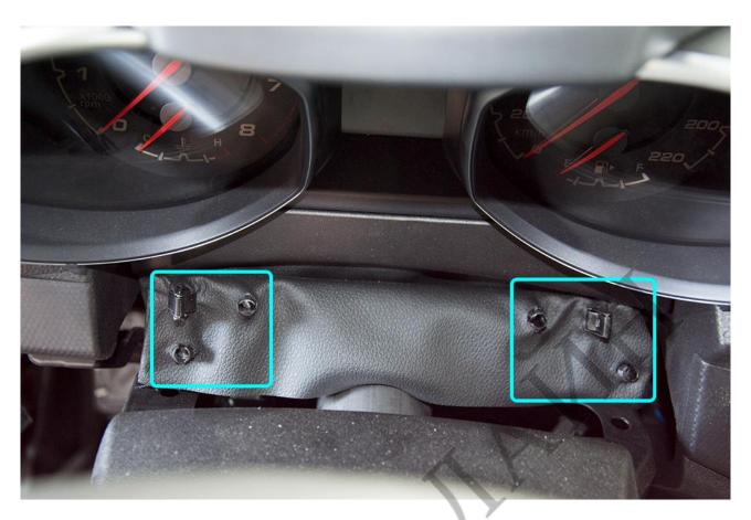
Расщёлкните крепления кожуха рулевого вала и снимите обе половины. Кожух снят. Общий вид.
