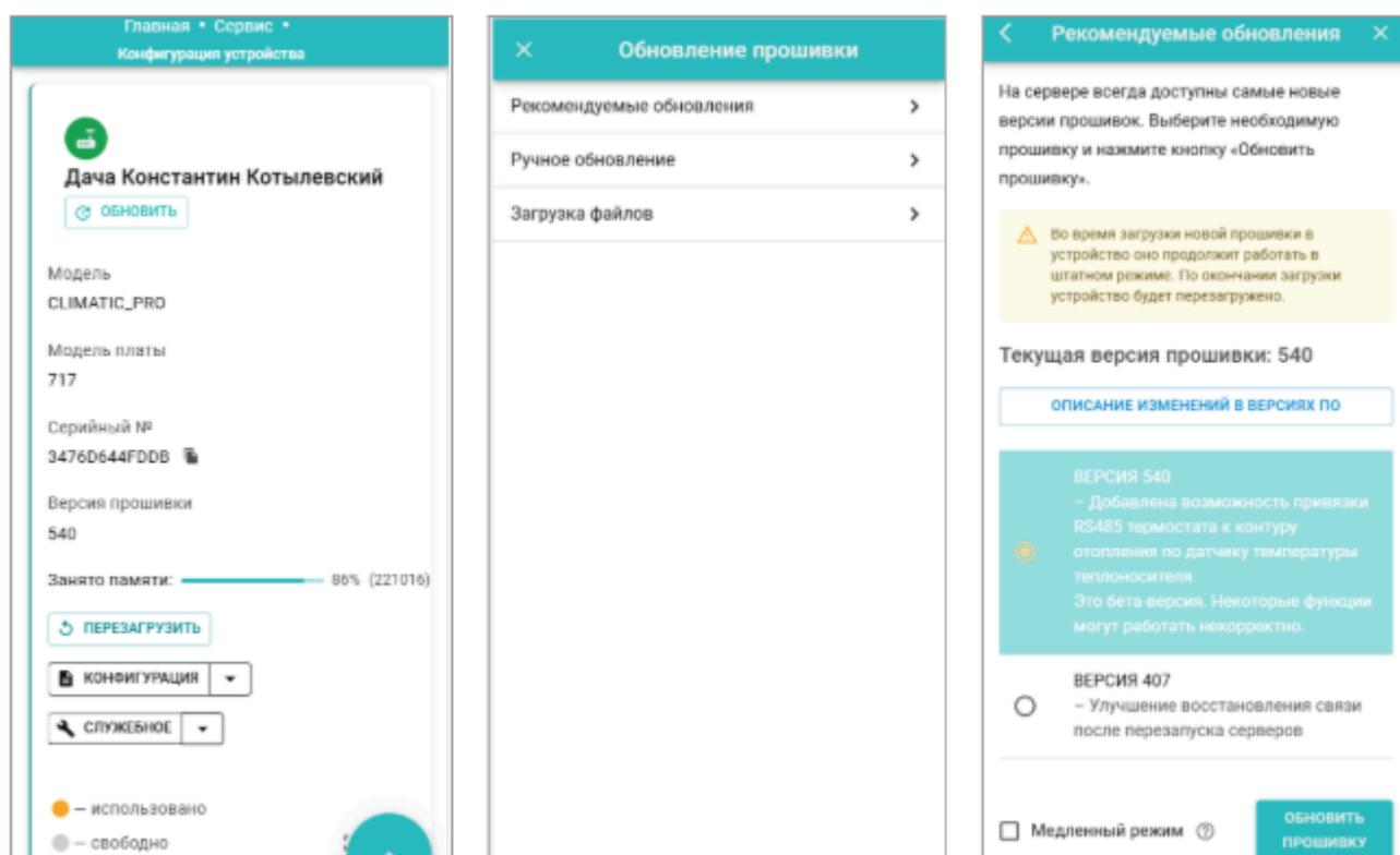
**ВНИМАНИЕ!!!** Во время обновления нельзя отключать Регулятор от сети питания. В случае отключения основного питания и не полностью заряженном резервном аккумуляторе, может произойти сбой, что приведет к частичной неработоспособности Регулятора. Восстановление в этом случае возможно только через обращение в техническую поддержку производителя или в заводских условиях.
