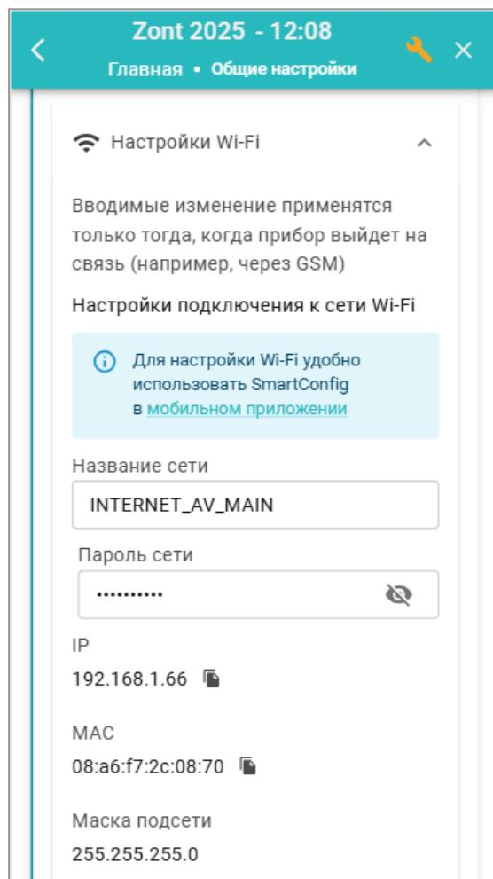
Регулятор разорвет соединение с сервером по GSM и установит соединение через Wi-Fi. При этом GSM связь останется в резерве.
