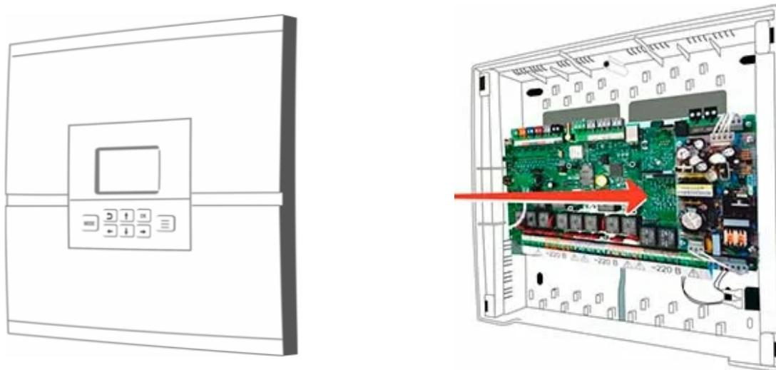
Панель управления съемная и при необходимости может быть установлена отдельно от Регулятора на удалении до 200 м. Корпус панели имеет элементы для крепления на плоскую поверхность. При установке панели управления отдельно от Регулятора на ее место устанавливается штатная заглушка из комплекта прибора. Обмен данными между Регулятором и панелью управления осуществляется по цифровому интерфейсу RS-485.
