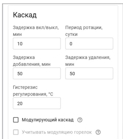
В каскаде котлы с задаваемой периодичностью меняются ролями (Основной / Ведомый), поэтому должны быть одинаковые по способу подключения к Регулятору и по мощности. Если котлы разные, то роли им задаются на постоянной основе – настроенный параметр *Ротация* задается равным 0, а Основной котел всегда подключается на первую позицию (к первой плате цифровой шины или первому релейному выходу).
