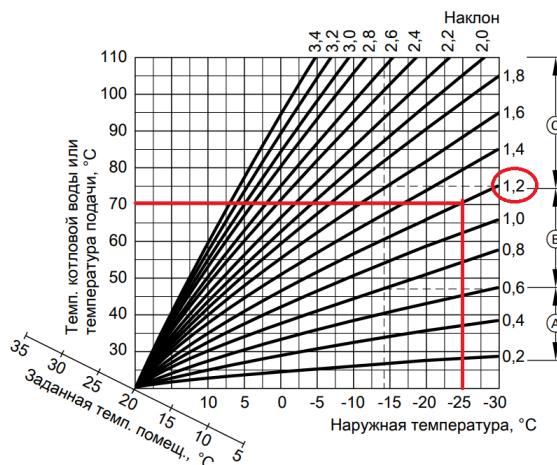
Основой алгоритма ПЗА является использование определенных зависимостей температуры вне дома и температуры теплоносителя, т.н. "Кривых ПЗА".
