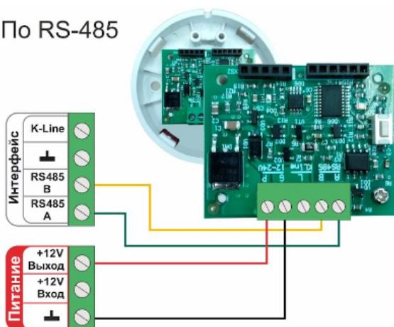
Датчик МЛ-778 для передачи данных на Регулятор использует интерфейс RS-485.
