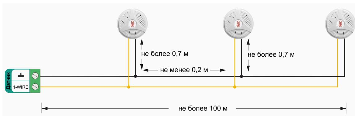
Подключение датчиков по трехпроводной схеме:
