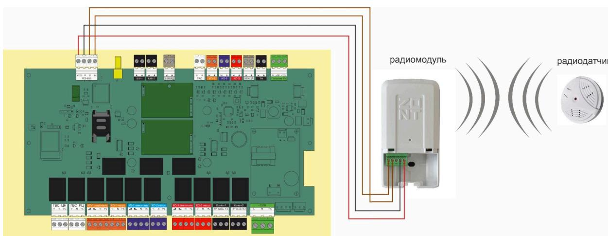
**ВНИМАНИЕ!!!** Радиодатчик температуры может быть использован **только для управления контуром отопления по воздуху**. Использовать его для контроля теплоносителя нельзя.
