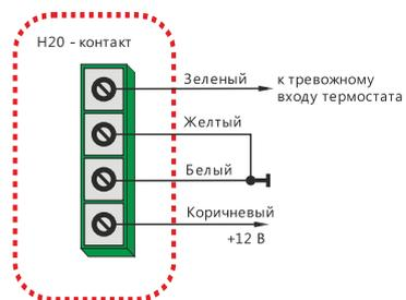
Датчик утечки газа срабатывает при появлении напряжения +12V
