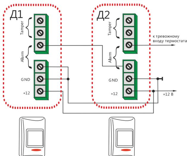
Подключение магнитно-контактного датчика
