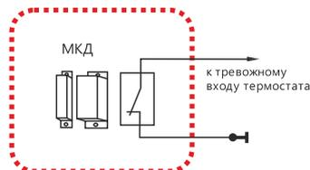
Датчики протечки питаются от шлейфа напряжением 3.3V и срабатывают при проседании напряжения ниже 2.4V
