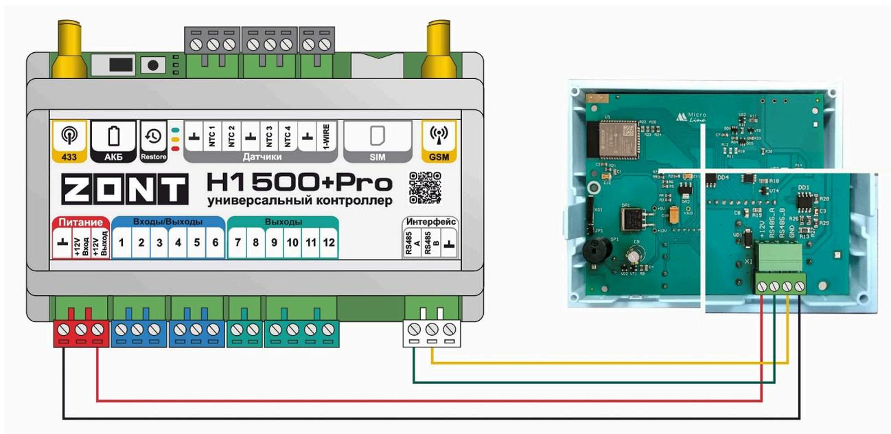
Пример подключения 3-х панелей по RS-485:
