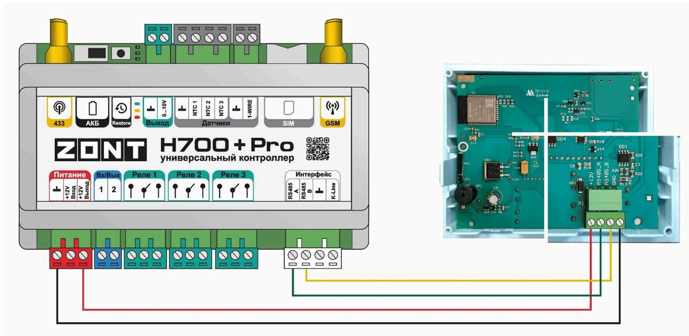
Пример подключения 3-х панелей по RS-485:
