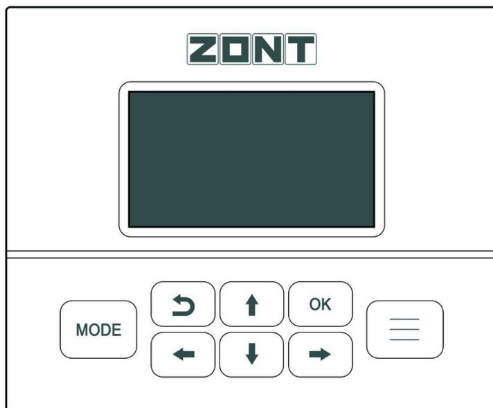
Панель управления имеет ЖК дисплей и кнопки управления.
