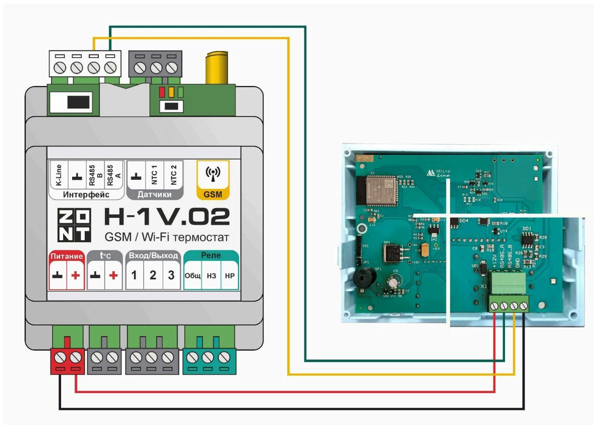
Пример подключения 3-х панелей по RS-485 (только H-1V.02):
