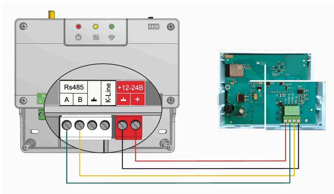
Пример подключения 3-х панелей по RS-485 (только SMART 2.0):
