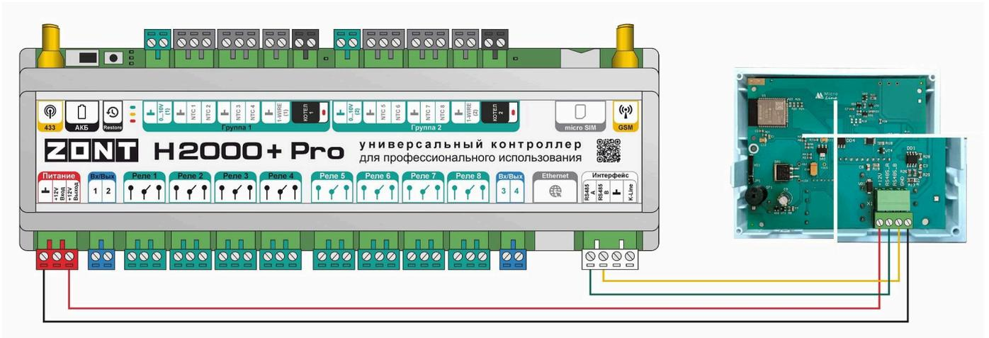
Пример подключения 3-х панелей по RS-485:
