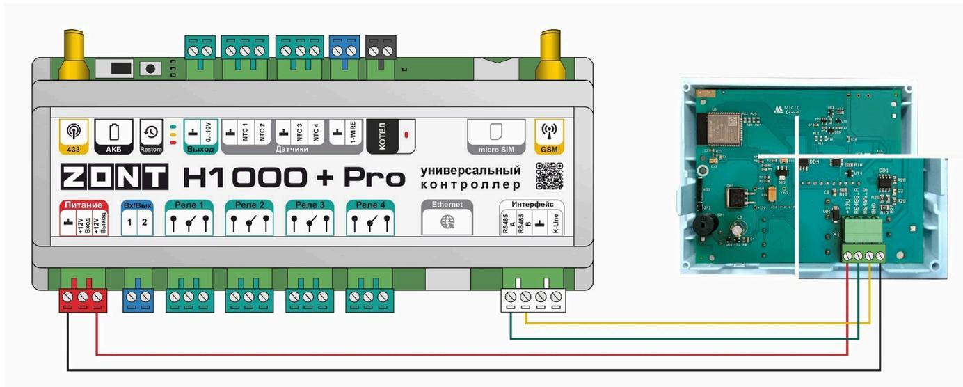
Пример подключения 3-х панелей по RS-485:
