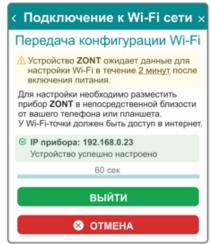
Примечание: Роутер должен быть заранее настроен на работу в диапазоне 2,4 гГц и раздавать интернет в режиме "router" (режимы "мост"/"bridge" непригодны). В настройках роутера должны
