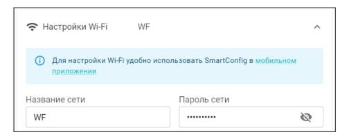
Для регистрации БР только в сети Wi-Fi предназначена функция **SmartConfig - автоматический поиск сети Wi-Fi.** Для ее запуска смартфон с приложением ZONT необходимо предварительно подключить к этой же сети Wi-Fi и на несколько секунд выключить основное питание БР. Затем нужно включить питание БР, указать имя и пароль сети, и после этого нажать кнопку "Передать в устройство".
