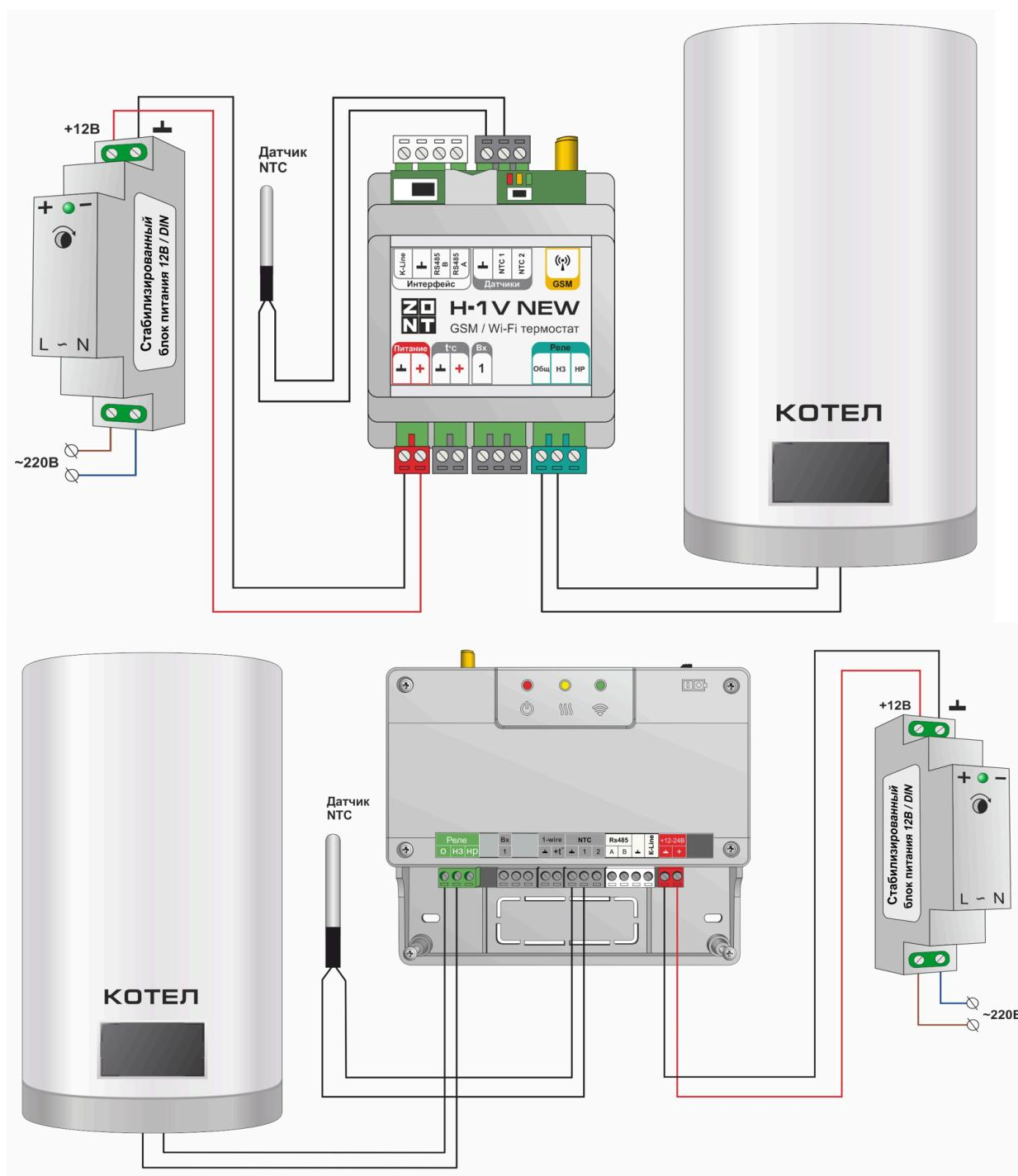
При расширении базовой комплектации дополнительным устройством адаптером цифровых шин, Термостат управляет котлом **цифровым способом**.
