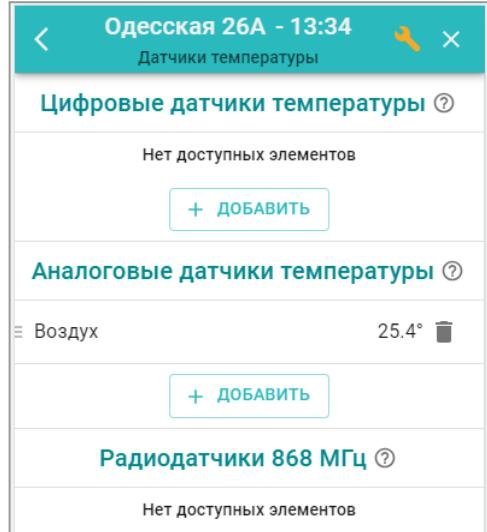
**Аналоговые датчики температуры NTC-10** к Термостату можно подключить в количестве не более 3-х шт. В комплект поставки входит один датчик. Датчики NTC-10 рекомендуется подключать к специальными входам Термостата, имеющим маркировку NTC .
