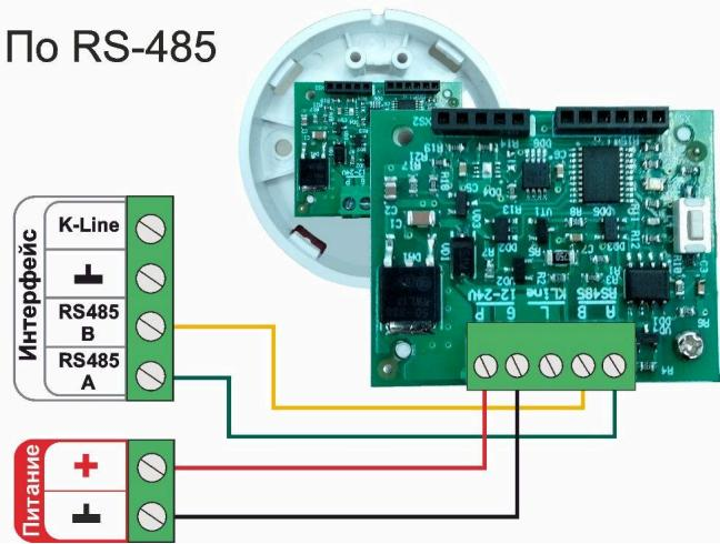
Допускается подключение только оригинальных датчиков температуры ZONT МЛ-778 и датчиков температуры / влажности МЛ-779. Сторонние датчики других производителей по интерфейсу RS-485 с Термостатом работать не могут.
