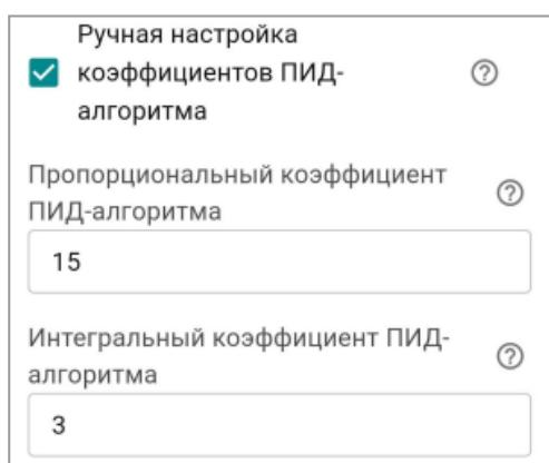
Настройка регулятора производится с целью подобрать коэффициенты таким образом, чтобы поддерживать целевую температуру воздуха без значительных колебаний. Увеличение коэффициентов тормозит алгоритм, уменьшение ускоряет.
