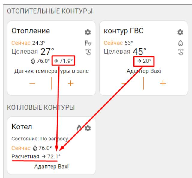
Параметр “Запрос на тепло” применяется только в Отопительном контуре, где для поддержания целевой температуры требуется повышать температуру на подаче котла.
