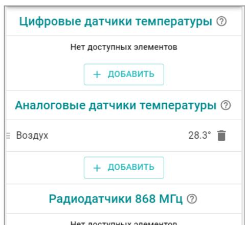
В базовой комплектации к Термостату подключается один аналоговый датчик NTC-10. Он используется в качестве источника информации о фактической температуре среды (воздуха или теплоносителя) по которой управляется работа котла на Отопление.
