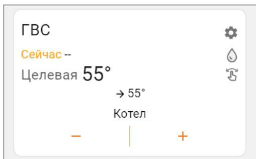
При отсутствии данных от датчика температуры, по которому производится регулирование в контуре, вместо значения температуры будет отображаться прочерк **Сейчас --**
