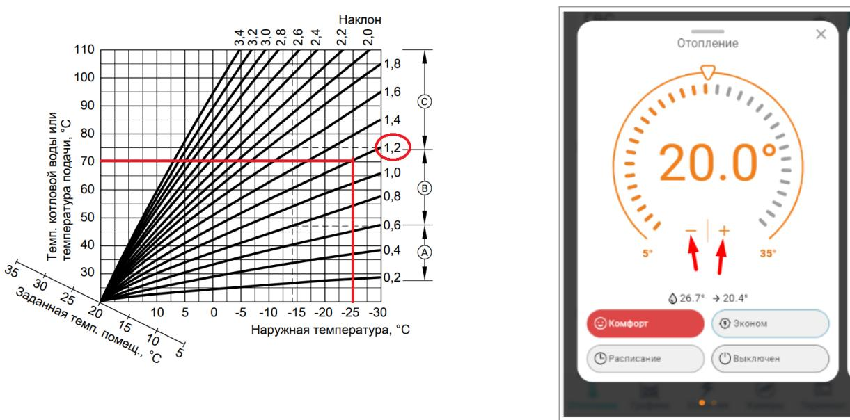
Значение параметра "запрос на тепло" при регулировании с ПЗА может быть задано только "Требуемая теплоносителя" или "Требуемая теплоносителя+XX". Фактическая температура теплоносителя при этом будет определяться выбранной кривой и заданным способом регулирования:
