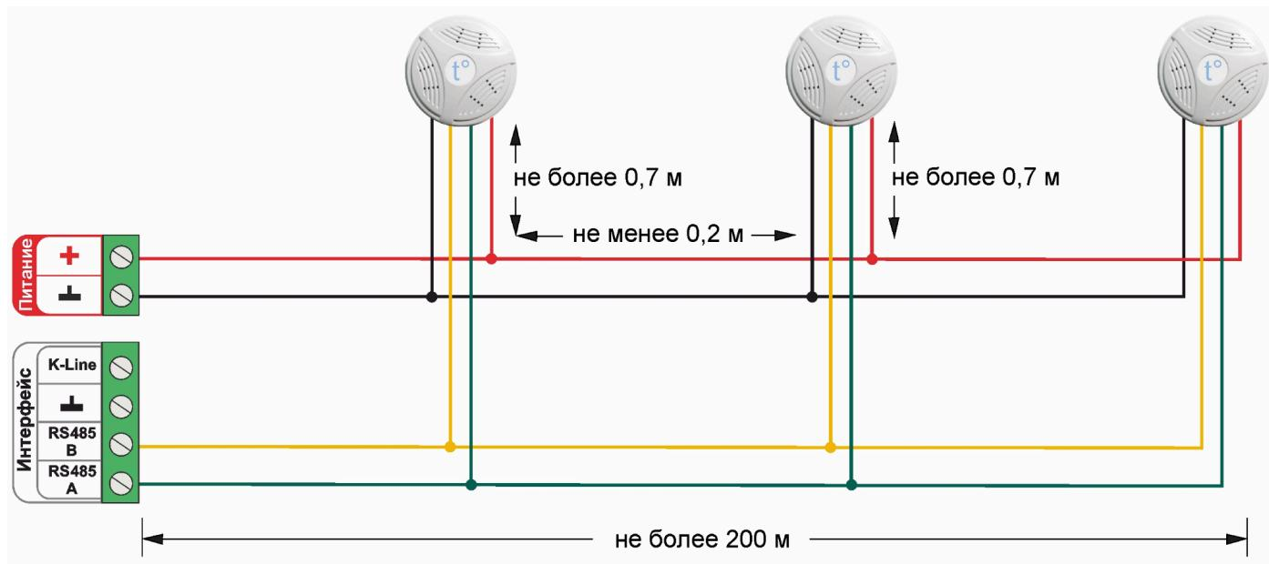
Подключение нескольких датчиков по K-Line:
