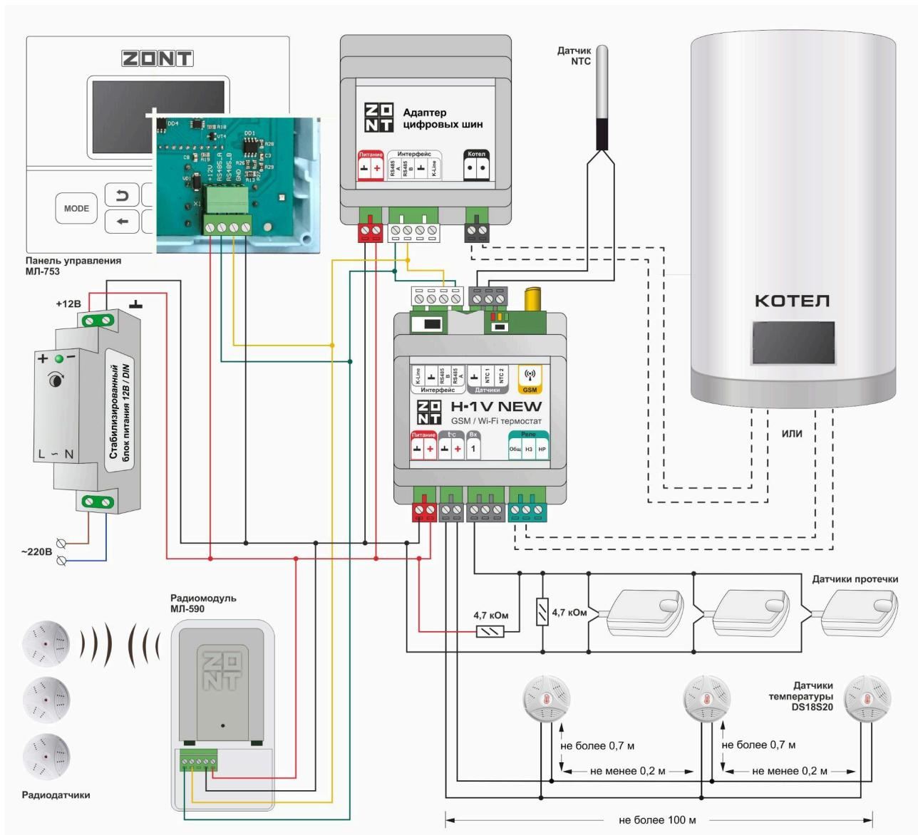
**Примечание:** Резервный аккумулятор при эксплуатации Термостата должен быть во включенном состоянии. Он поддерживает работу внутренней схемы Термостата (процессора, модемов GSM и Wi-Fi, портов K-Line и RS-485), проводных датчиков температуры, а также датчиков подключенных к аналоговому входу (при условии, что они запитаны от резервируемого источника питания).
