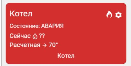
В окне детальной информации контура котла появляется код ошибки, который передает котел по цифровой шине, возможная причина ошибки и метод ее устранения.
