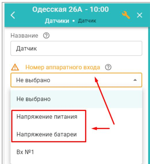
Для формирования оповещений об отключении и восстановлении напряжения питания необходимо указать нижний и верхний пороги срабатывания функции контроля и включить параметр “Событие на сервер при срабатывании”.
