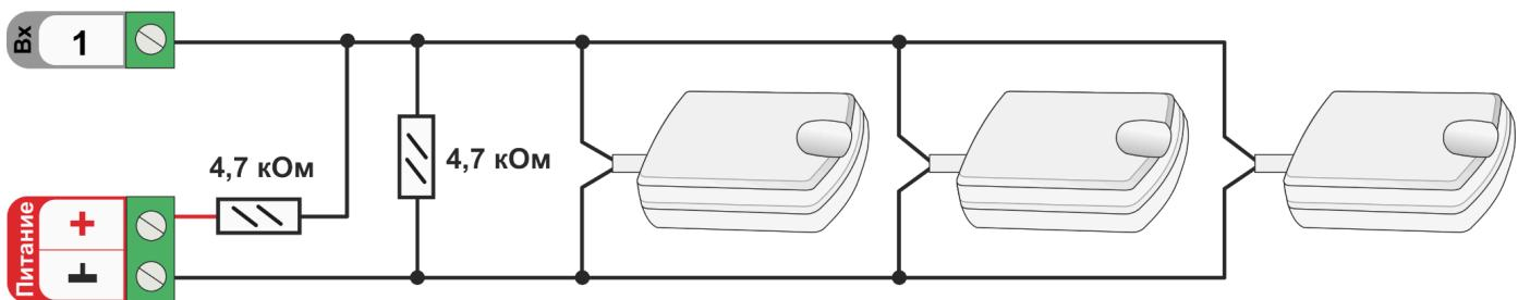
**ВНИМАНИЕ!!!** Датчики протечки Астра 361 имеют полярность. При несоблюдении полярности датчик не имеющий контакта с водой показывает сработку.
