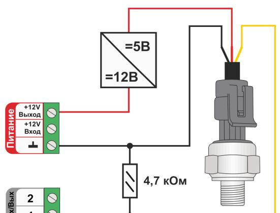
**Примечание:** Резистор подтяжки номиналом 4,7 кОм устанавливается только если входу Термостата, к которому подключен датчик давления, настройкой назначен оригинальный тип сенсора. В этом случае при “обрыве датчика” формируется соответствующее событие. Если тип сенсора назначен “аналоговый вход” – резистор не нужен.
