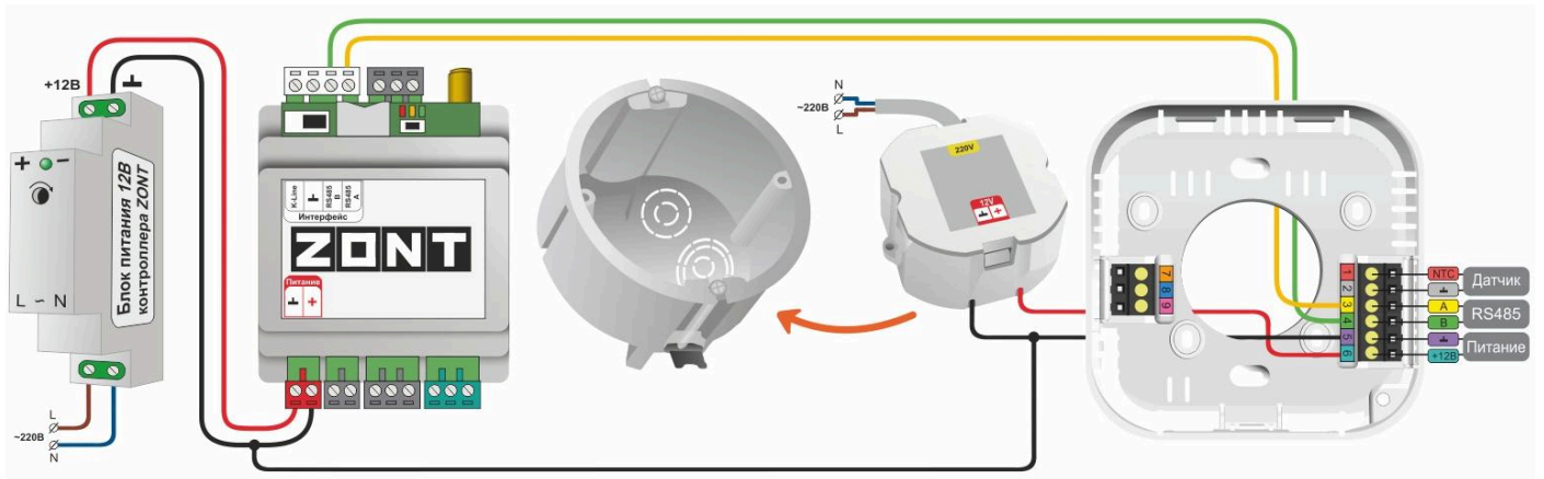
питание Термостата от отдельного блока питания
