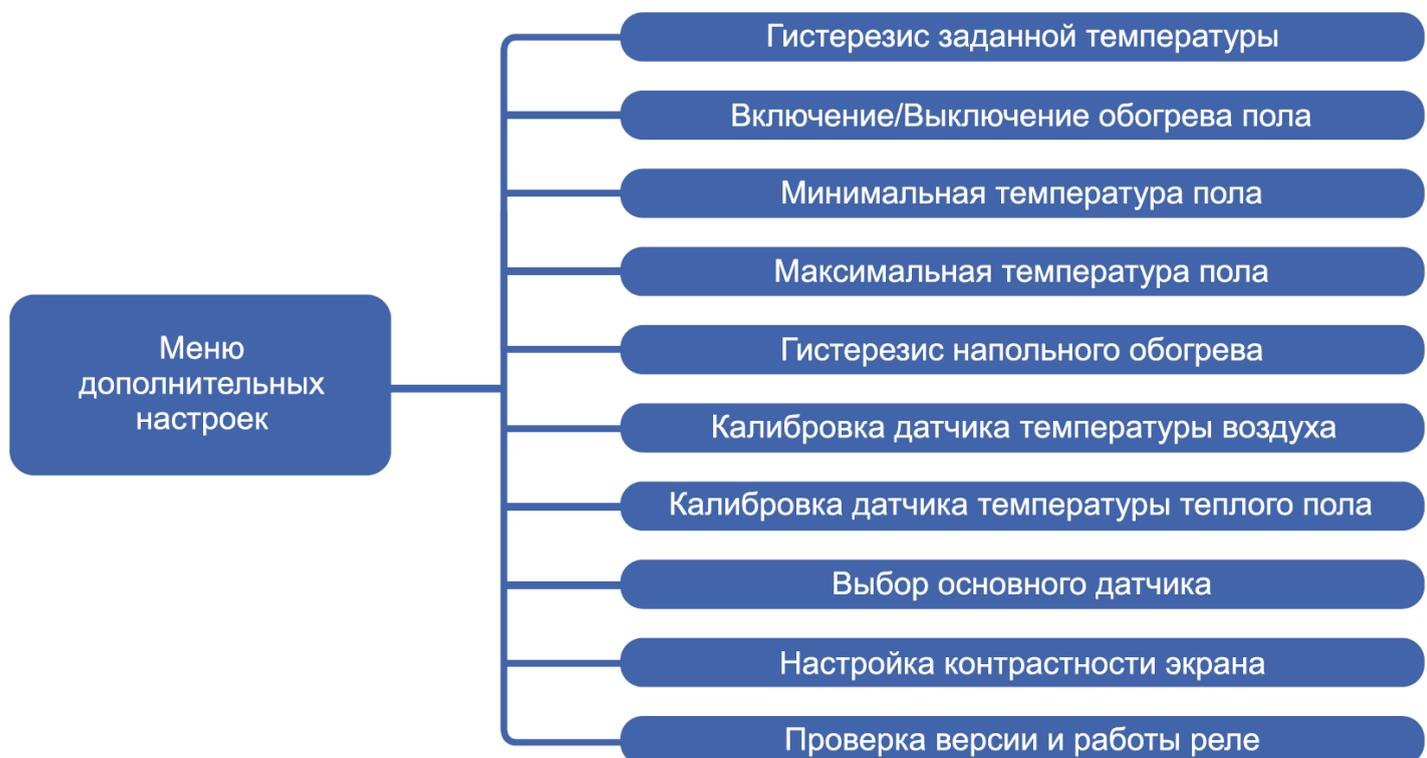
*Примечание:* Пункты настройки параметров для датчика температуры пола, отображаются только при активном (включенном) режиме работы Термостата с обогревом пола.
