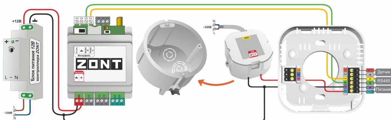
питание Термостата от отдельного блока питания
