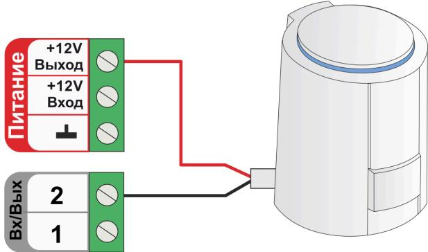
Схема подключения к релейному выходу:
