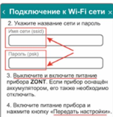
**ВНИМАНИЕ:** Для успешного подключения надо уточнить какой диапазон рабочих частот у маршрутизатора – 2,4 ГГц или 5 ГГц и выбрать именно 2.4 ГГц, Если маршрутизатор двухдиапазонный, то при вводе данных указать пароль для точки доступа на 2,4 ГГц. Маршрутизатор должен раздавать интернет в режиме "router" (режимы "мост"/"bridge" непригодны). В настройках маршрутизатора должен быть выбран код шифрования WPA2 и использование 2G BGN TKIP AES или без защиты.
