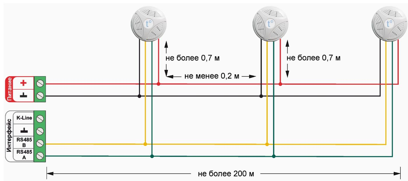
Подключение нескольких датчиков по K-Line:
