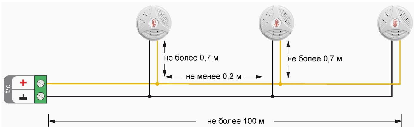
Подключение датчиков по трехпроводной схеме:
