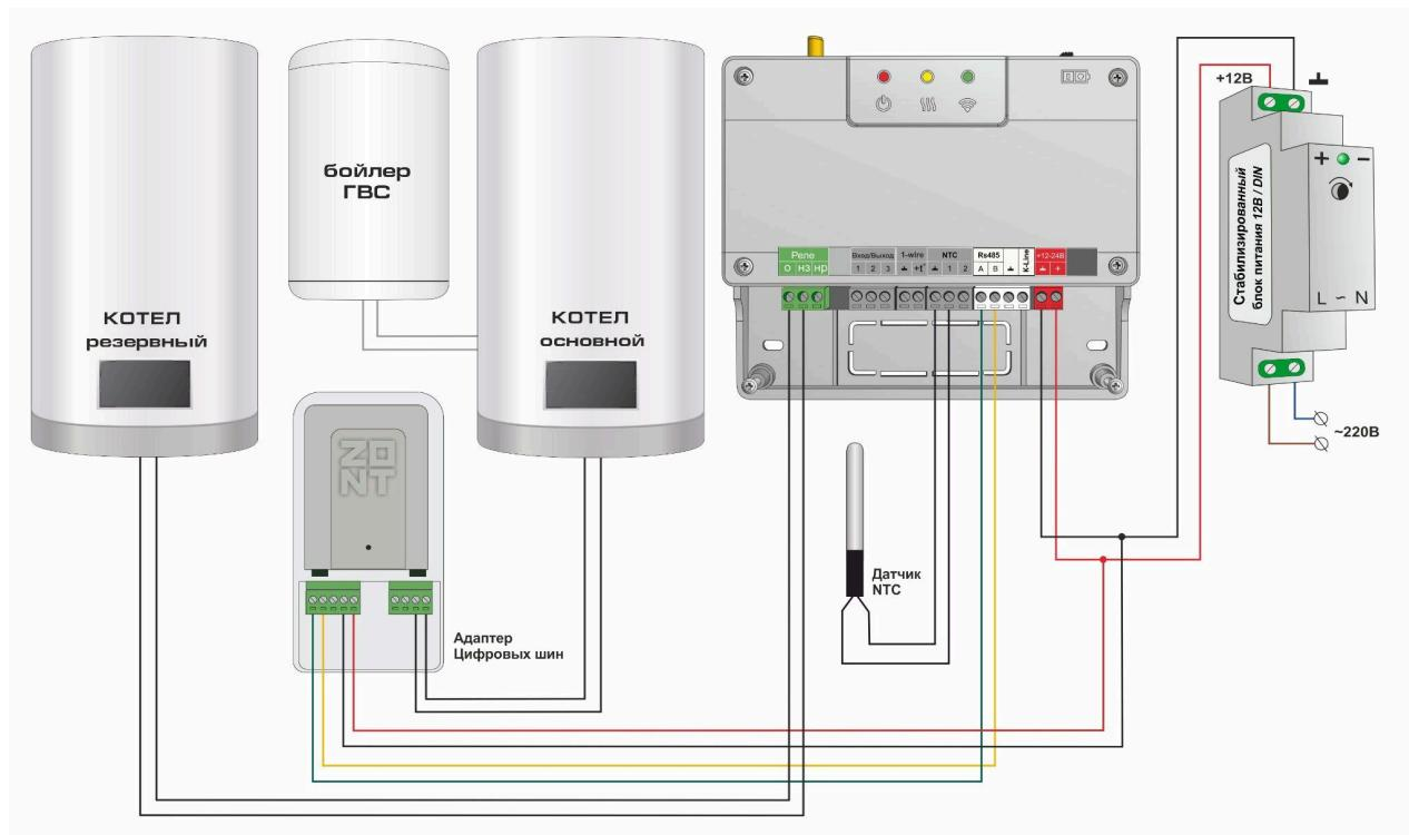
При таком подключении Контроллер считывает из цифровой шины котла фактическую температуру теплоносителя и другие параметры его работы, сравнивает целевую и текущую температуры воздуха в помещении или теплоносителя в системе отопления и рассчитывает
