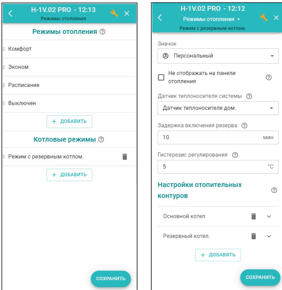
**Датчик теплоносителя системы** – источник информации о температуре теплоносителя в гидрострелке. Это отдельный датчик, контролируемый входом Контроллера. Физически датчик устанавливается на гидрострелке в зоне подачи теплоносителя.
