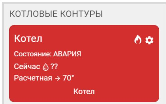
В окне детальной информации контура котла появляется код ошибки, который передает котел по цифровойшине, возможная причина ошибки и метод ее устранения.
