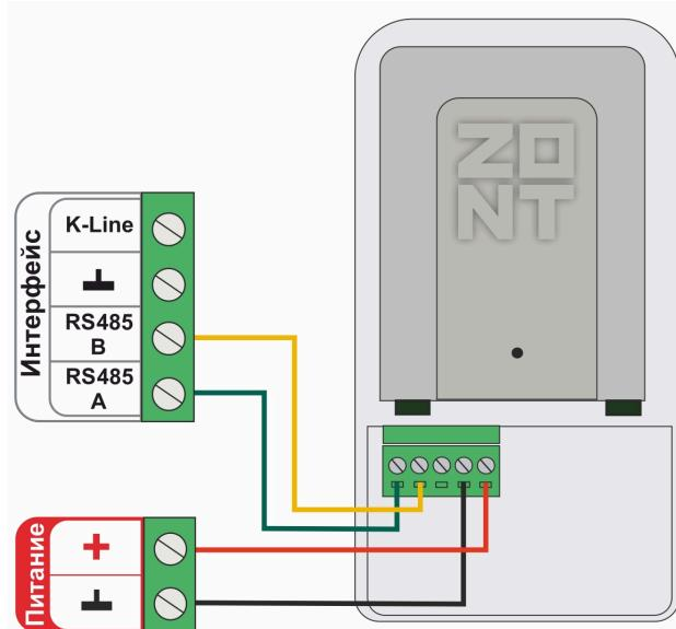
Схема подключения радиомодуля по K-Line:
