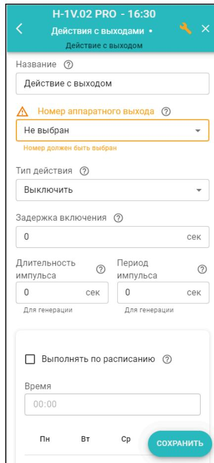
**Генерация импульсов** – алгоритм включения выхода Контроллера с заданными длительностью и периодом. Импульс включения выхода на заданную длительность формируется один
