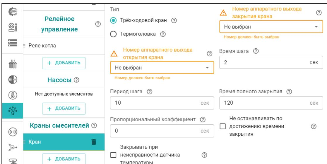
Для обеспечения плавного регулирования температуры теплоносителя в контуре необходимо импульсное управление вращением привода в сторону “открывания” и “закрывания”. При подаче каждого импульса привод перемещает шток крана на определенный угол или смещает клапан на определенное расстояние. При настройке задается **Период шага** – время между первым и следующим включением и **Время шага** – время в течении которого на привод подается напряжение.
