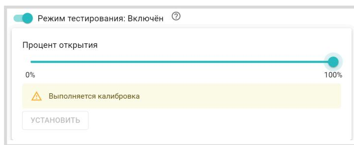
**ВНИМАНИЕ!!!** Используйте “Режим тестирования” только при пусконаладочных работах. Включение режима во время работы Контроллера нарушает алгоритм управления выходом. Контроллер после того необходимо перезапустить по питанию.
