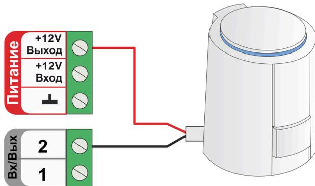
Схема подключения к релейному выходу:
