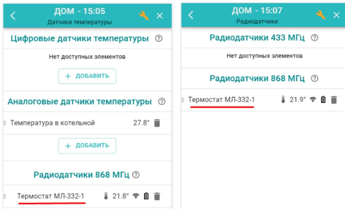
В конфигурации Контроллера ZONT Термостат применяется или как датчик температуры по которому регулируется отопительный контур, или как источник данных для мониторинга температуры в месте его установки. Из личного кабинета сервиса ZONT пользователь может дистанционно изменить значение целевой температуры Термостата. Для этого необходимо в конфигурации Контроллера создать отдельный отопительный контур с комнатным термостатом МЛ-332 в качестве датчика температуры.
