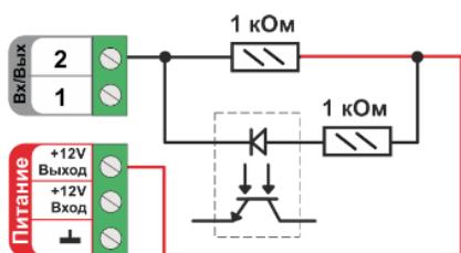
Особенность этой схемы заключается в том, что оптореле может включаться (загорится внутренний светодиод оптрона) даже от малого тока через цепь +3,3 В - 100 КОм - оптрон - +12 В. Чтобы этого не произошло, рекомендуем включить дополнительные резисторы номиналом 1 КОм.
