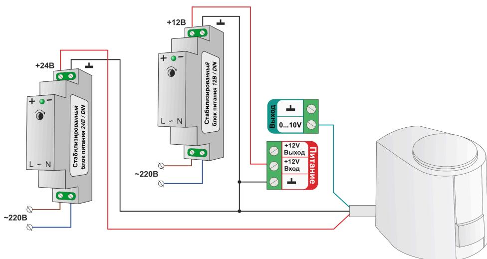
**ВНИМАНИЕ!!!** Некоторые приводы запитываются от источников питания переменного тока. В тех случаях когда привод имеет три вывода - два из которых питание привода и третий управляющий -
