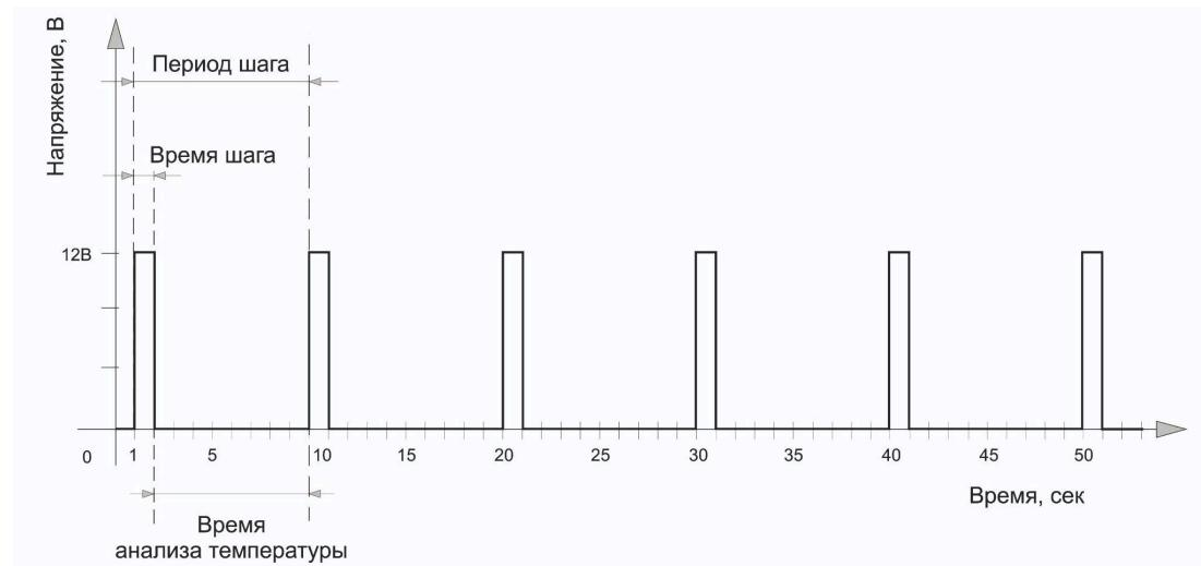
**Период шага** для управления трехходовым краном настраивается в пределах от 10 до 180 секунд. Для управления двухходовым краном (термоэлектрическим клапаном) он всегда равен 10 сек. и не может быть изменен настройкой)
