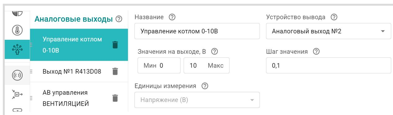
В результате такой настройки “запрос на тепло” к котловому контуру из расчетной температуры теплоносителя будет преобразован в управляющее напряжение и через аналоговый выход поступит на аналоговый вход 0-10 В котла.
