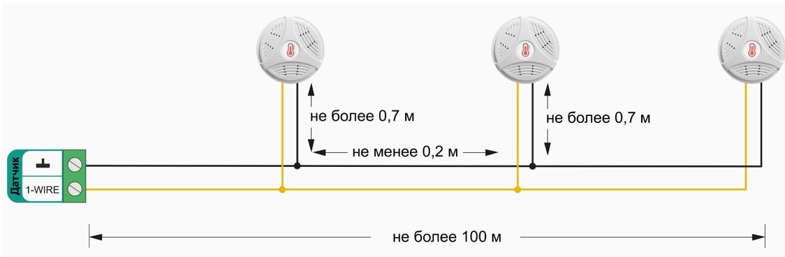
Подключение датчиков по трехпроводной схеме:
