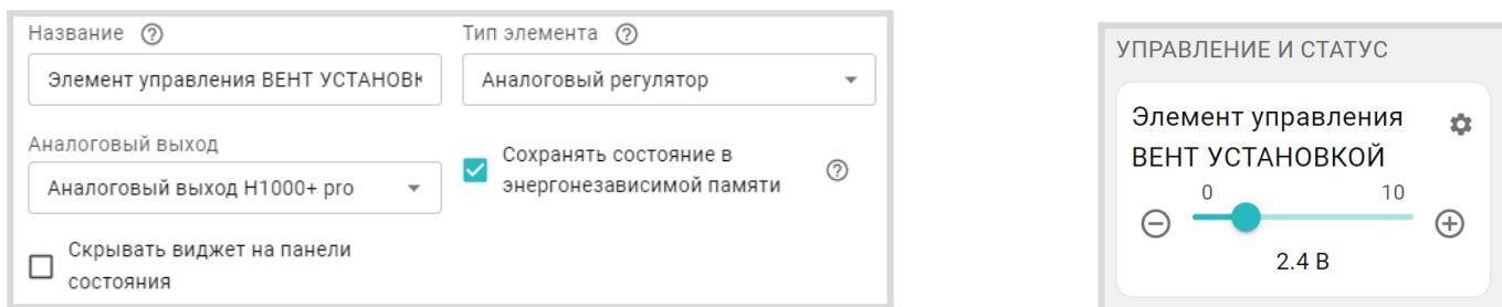
При этом в сервисе, в блоке Управление и Статус будет отображен Элемент управления аналоговым выходом 0-10В. Перемещая ползунок шкалы напряжения, можно менять напряжение на аналоговом выходе и тем самым управлять работой исполнительного устройства вручную.
