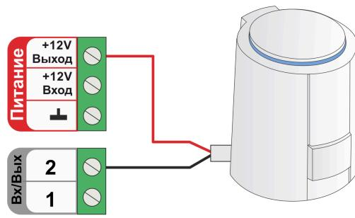
Схема подключения к релейному выходу:
