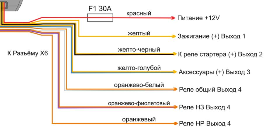
\*Импульсный сигнал о статусе двигателя (тахометр, форсунка) может быть подключен только к входу 4
