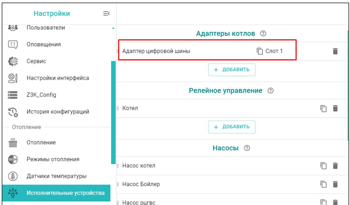
В настроечных параметрах Адаптера цифровой шины нужно проверить и при необходимости указать тип цифровой шины Modbus RTU и модель подключенного котла:
