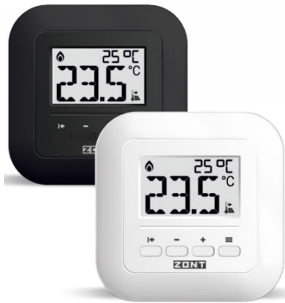
Комнатный термостат ZONT МЛ-232 предназначен для поддержания постоянной температуры в отдельной зоне обогрева. После соединения с Контроллером через интерфейс RS-485, термостат определяется в личном кабинете Приложения BAXI CONNECT+ как новый цифровой датчик температуры. Он отображает данные о температуре в месте установки (зоне отопления) по показаниям от датчика, выбранного настройкой термостата в качестве основного.
