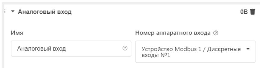
Для настройки Входа нужно выбрать в поле “Номер аппаратного входа” регистр устройства Modbus.
