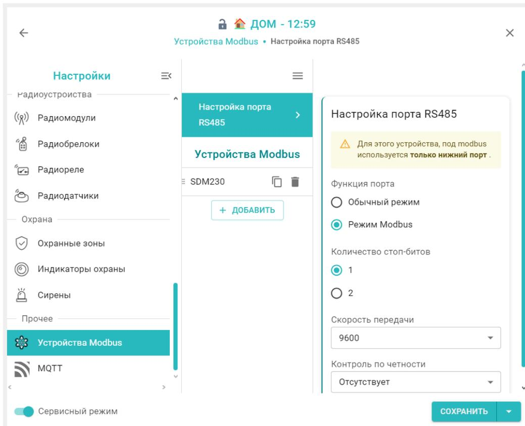
Параметр **Скорость передачи** определяет скорость передачи информации по интерфейсу RS-485. Скорость передачи должна быть установлена не больше, чем может поддерживать используемое устройство.
