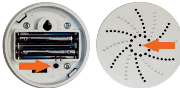
**Примечание:** напряжение элемента питания датчика (батарейки) должно быть не менее 2,8 В.
