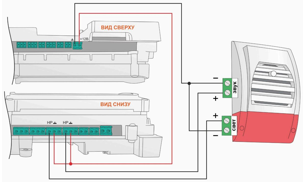
**Примечание:** В неактивном состоянии выхода ОК из-за утечки тока при подключении нагрузки с высоким сопротивлением, у некоторых типов светозвуковых оповещателей (например МАРС-12 КП), может наблюдаться слабое свечение светодиода и треск или писк динамика. Для исключения такого эффекта рекомендуется подключать оповещатели через промежуточное реле.
