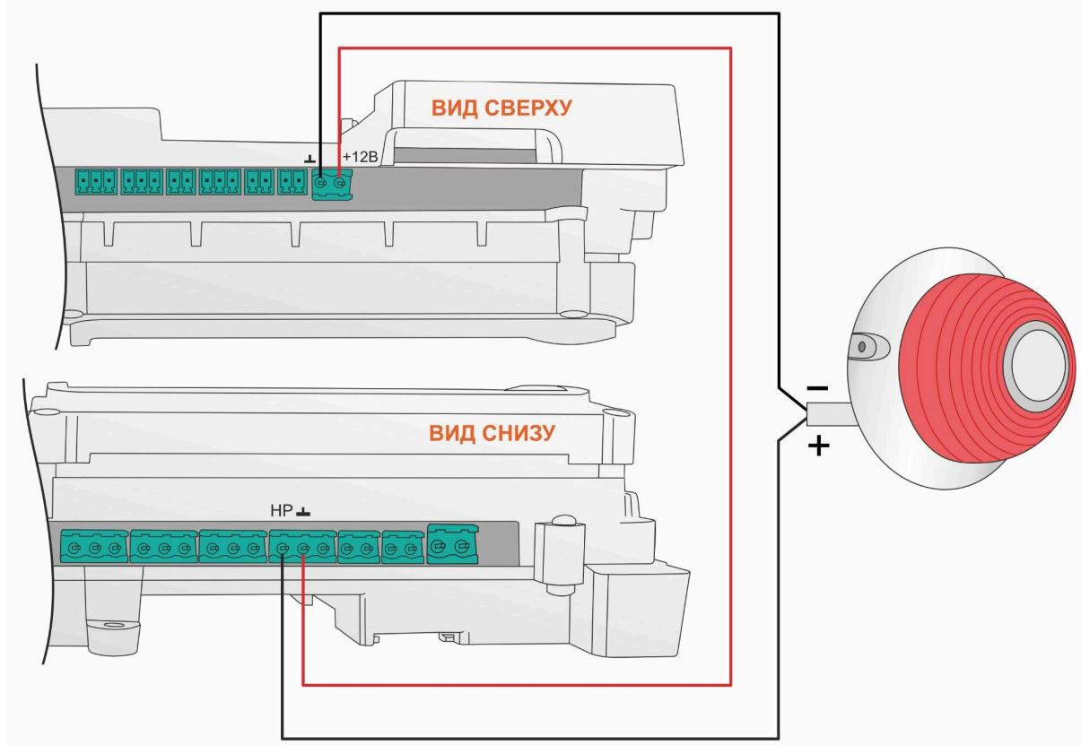
Для подключения **светозвуковых оповещателей** используются два выхода контроллера.
