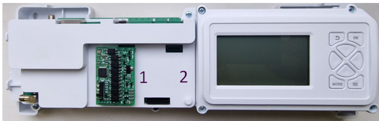
Внешний вид Регулятора со снятой лицевой крышкой. Позиции 1 и 2 – места установки плат цифровых шин.
