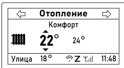
**Примечание:** В котловом контуре задать каким либо образом целевую температуру нельзя, т.к. это значение рассчитывается контроллером по фактическим величинам “запроса на тепло” от отопительных контуров и контура ГВС.
