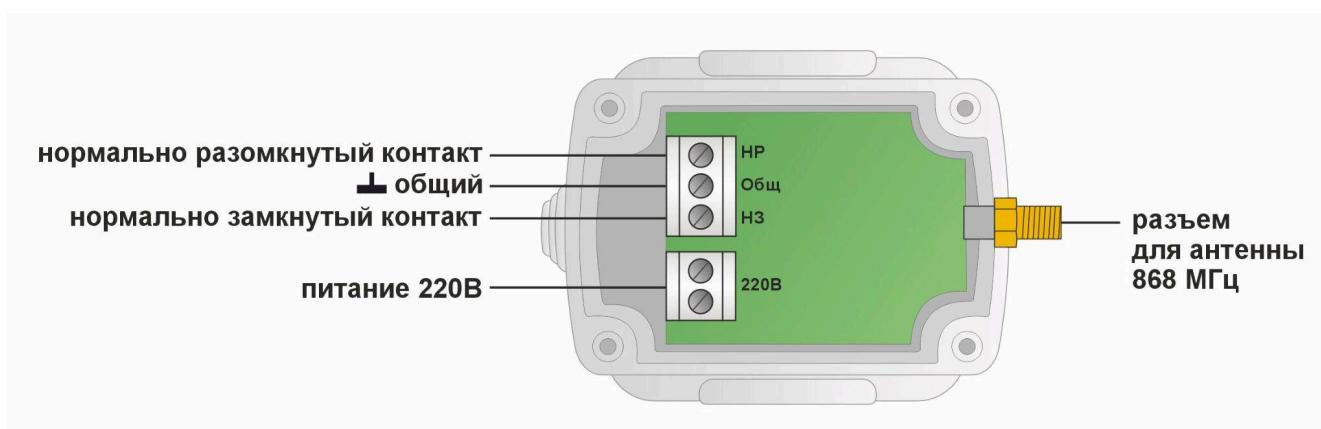
Антенна из комплекта Радиореле используется при необходимости обеспечить максимальную дальность действия радиоканала. При использовании антenna ориентируется в сторону расположения радиомодуля МЛ-590 в новом корпусе или МЛ-595.
