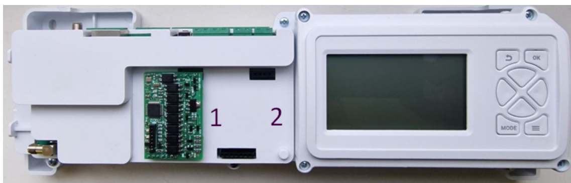
Внешний вид контроллера со снятой лицевой крышкой. Позиции 1 и 2 – места установки плат цифровых шин.
